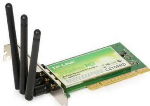
*Рис. 6.22. PCI Wi-Fi-адаптер*
