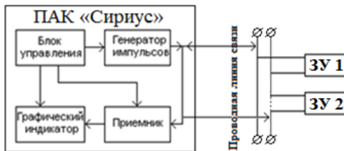
Рисунок 1. Схема подключения ПАК «Сириус» к проверяемой линии связи
