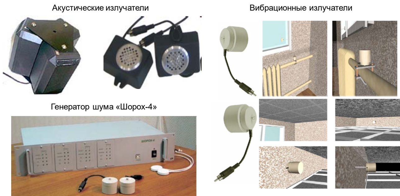
Рисунок 4. Пример размещения средств активной защиты речевой информации
