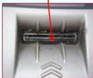
ФАЛЬШ- НАКЛАДКИ ДЛЯ СЧИТЫВАНИЯ МАГНИТНОЙ ПОЛОСЫ КАРТЫ
