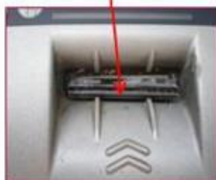
ФАЛЬШ- НАКЛАДКИ ДЛЯ СЧИТЫВАНИЯ МАГНИТНОЙ ПОЛОСЫ КАРТЫ
