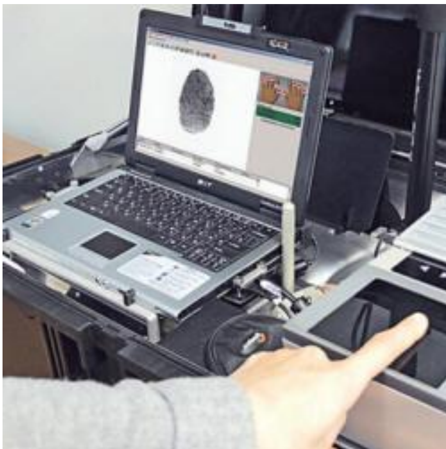
Рис. 2.1. Система электронного бескраскового дактилоскопирования «Папилон» «Живой сканер»
