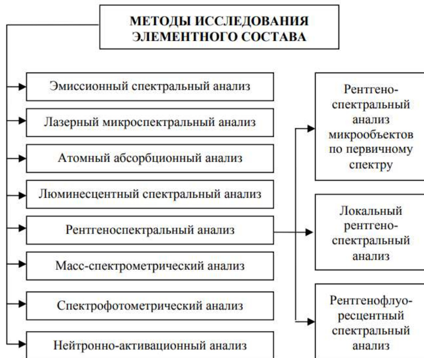
Рис. 2. Система методов исследования элементного состава веществ и материалов
