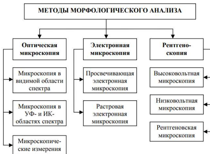
Рис. 1. Схема микроскопических методов исследования веществ и материалов
