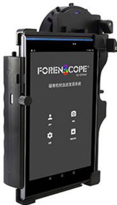
Рис. 2. Мобильное устройство в виде планшетного компьютера и спектрального осветительного устройства «Forenscope»
