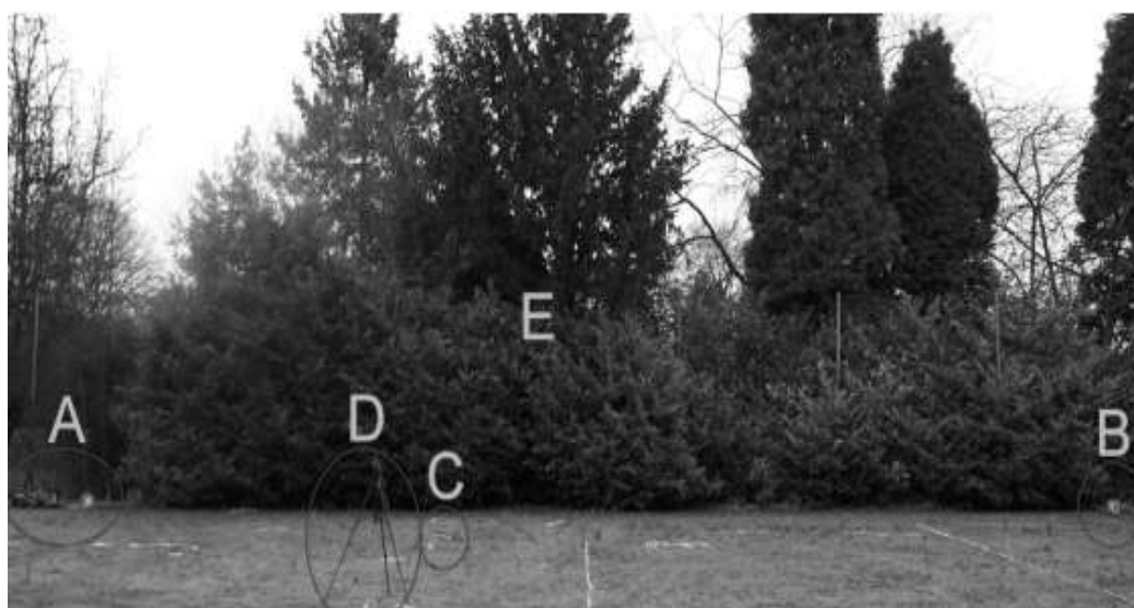
Рис. 1. Вид-схема эксперимента: А — блок приёмника; В — передающая антенна (передатчик); С — анемометр, измеряющий скорость и направление ветра; D — видеокамера
