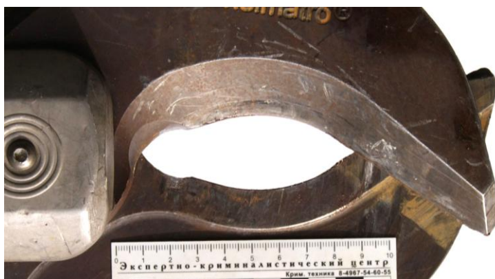
Рис. 2. Рабочие поверхности ножей гидравлического резака Holmatro CU 4055 NCT II
