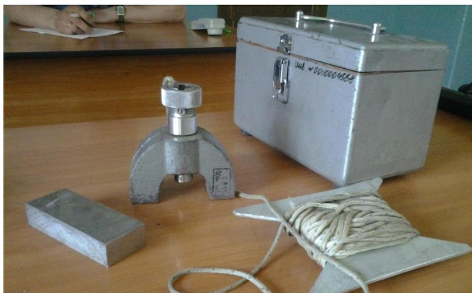
Рис. 14. Магнитный искатель-подъемник
