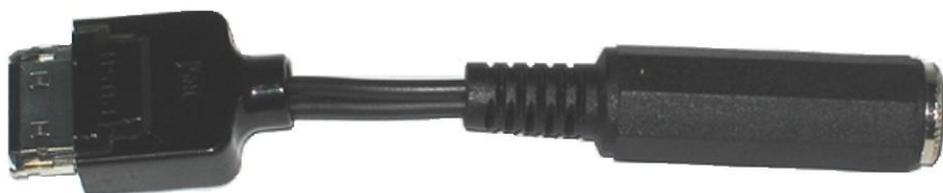
Рис. 29. Кабель для подключения головных телефонов
