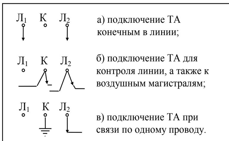
Рис. 2. Способы подключения ТА-57 к линейным проводам
