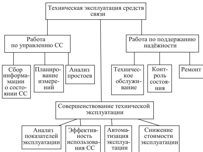
Рис. 3.1. Основные виды работ технической эксплуатации
