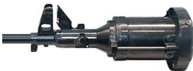
Универсальная насадка для отстрела специальных средств из стрелкового оружия «Отстрел» на стволе автомата
