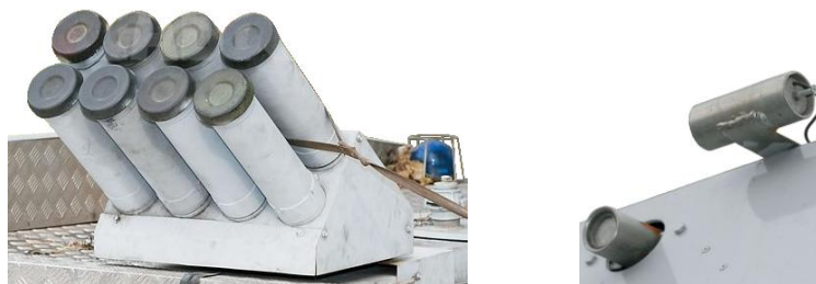
Гранатомет «Туча» и видеокамеры на крыше спецавтомобиля
