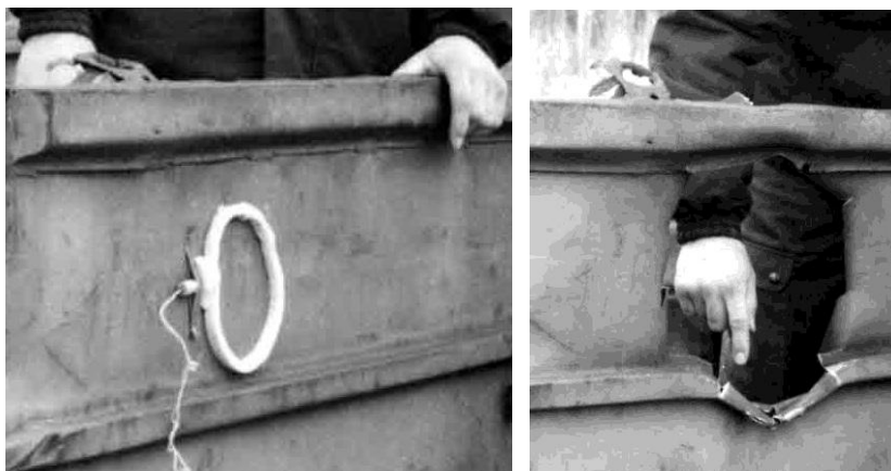
Пример установки МВУ на металлической преграде и пробитого им отверстия
