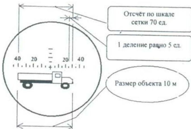
Рис. 2. Определение дальности до объекта по угломерной шкале
