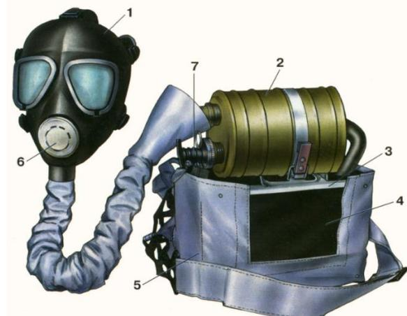
Рис. 20. Изолирующий противогаз ИП-4М: 1 – маска МИА-1; 2 – регенеративный патрон; 3 – каркас; 4 – дыхательный мешок; 5 – сумка; 6 – переговорное устройство; 7 – пусковое приспособление
