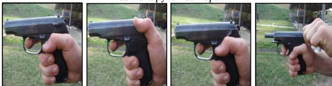
Рис. 33 б. Снятие пистолета с предохранителя и досылание патрона в патронник способом захвата рукой за заднюю часть затвора
