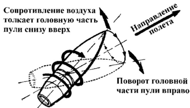
Рис. 8. Отклонение головной части пули в сторону от плоскости стрельбы
