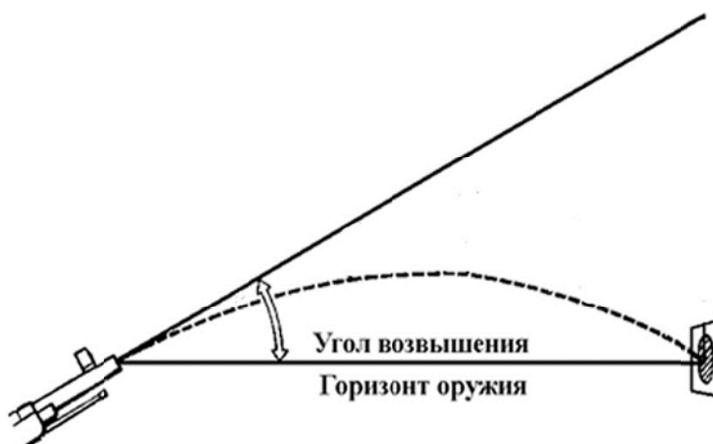
Рис. 3. Угол возвышения и горизонт оружия
