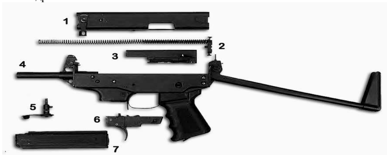
Рис. 41. Основные части и механизмы ПП-91 «Кедр» и ПП-9 «Клин»: 1 – крышка ствольной коробки; 2 – возвратный механизм; 3 – затвор; 4 – ствол со ствольной коробкой, открытым прицелом и складывающимся прикладом; 5 – предохранитель-переводчик; 6 – ударно-спусковой механизм; 7 – магазин
