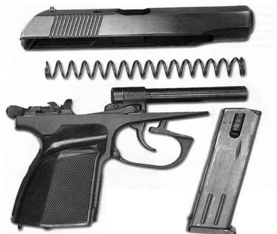
Рис. 29. Неполная разборка пистолета ПММ
