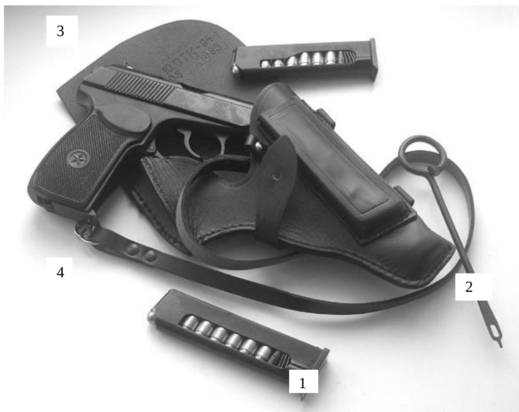
Рис. 20. Принадлежности к ПМ: 1 – запасной магазин; 2 – протирка; 3 – кобура; 4 – пистолетный ремешок
