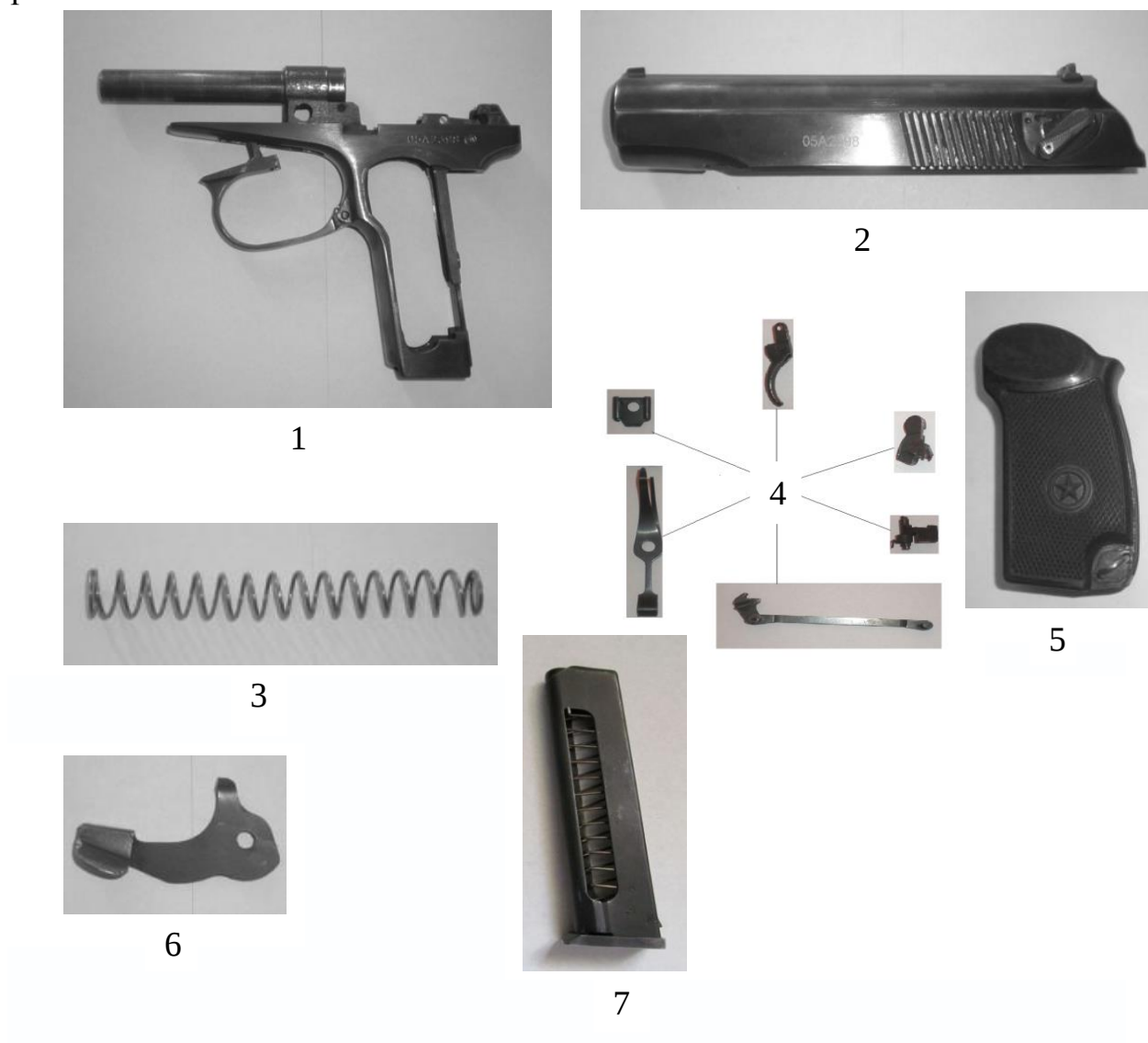
Рис. 19. Основные части пистолета Макарова:
