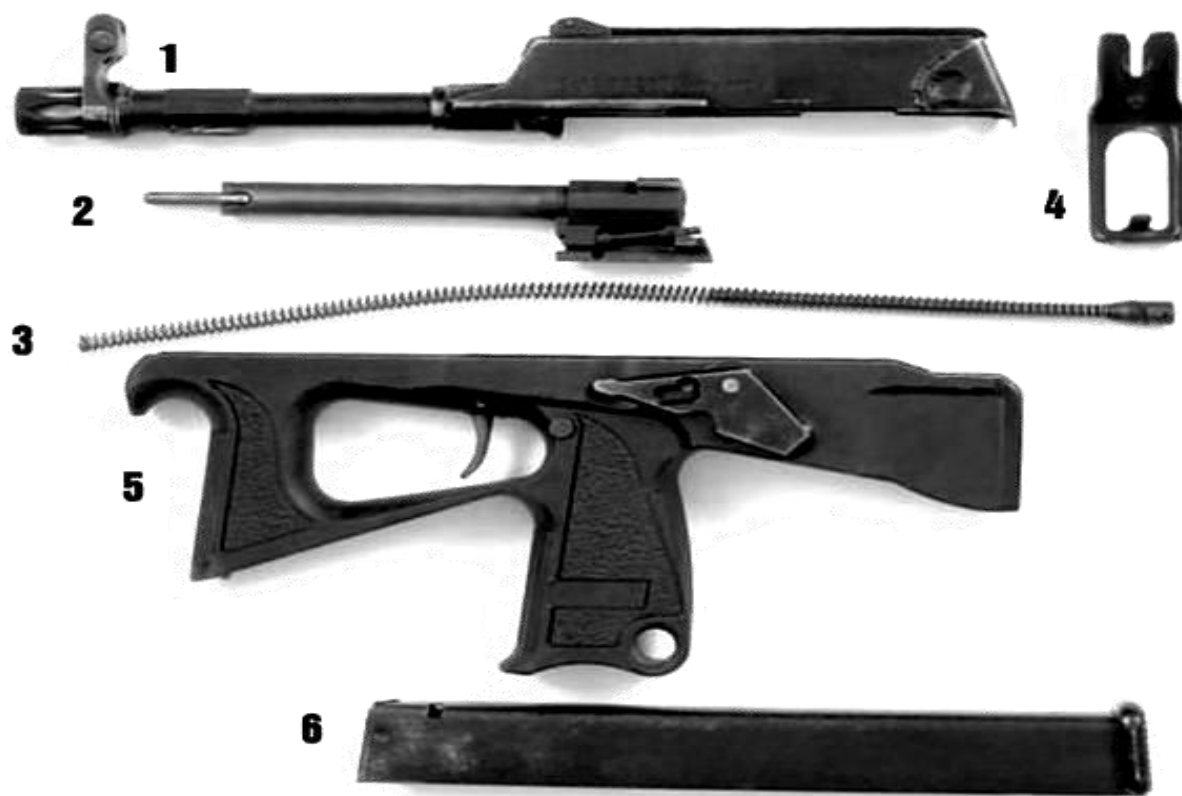
Рис. 45. Основные части и механизмы ПП-2000: 1 – ствол со ствольной коробкой; 2 – затвор; 3 – возвратный механизм; 4 – затыльник; 5 – рукоятка с ударно-спусковым механизмом; 6 – магазин
