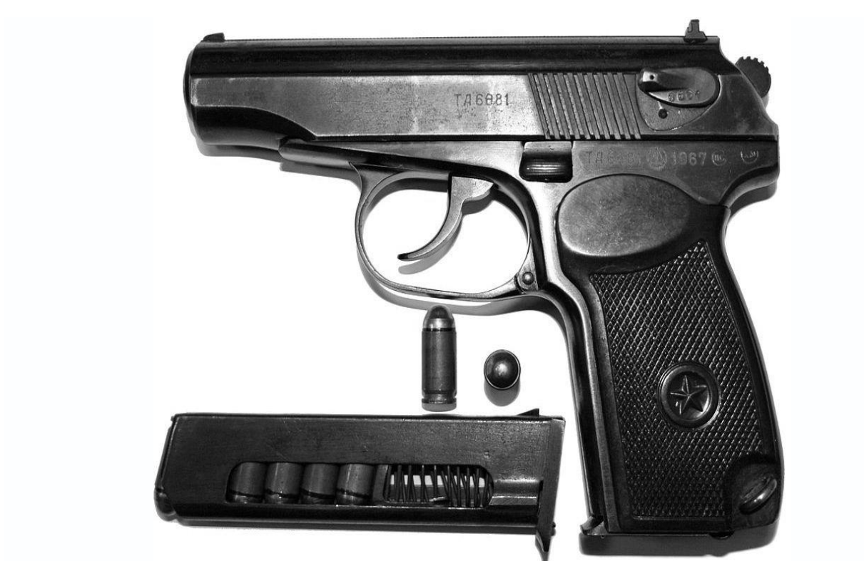
Рис. 18. 9-мм пистолет Макарова
