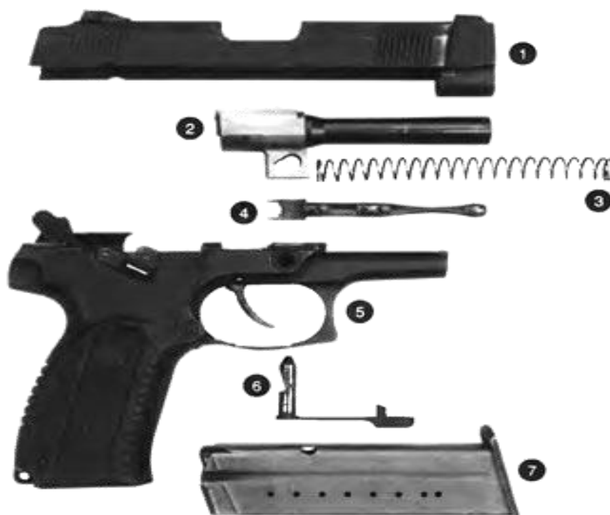
Рис. 31. Основные части и механизмы ПЯ:
