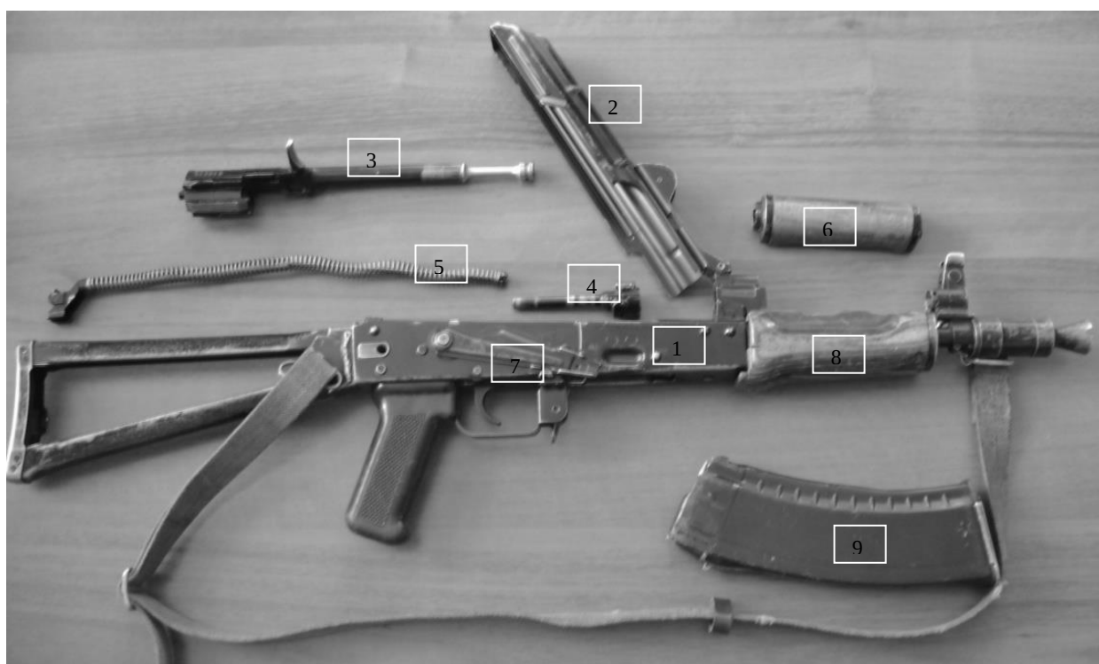
Рис. 36. Основные части и механизмы АК-74 и АКС-74У: 1 – ствол со ствольной коробкой, прицельным приспособлением, дульным тормозом-компенсатором (пламегаситель для АКС-74У), прикладом и пистолетной рукояткой, 2 – крышка ствольной коробки; 3 – затворная рама с газовым поршнем; 4 – затвор; 5 – возвратный механизм; 6 – газовая трубка со ствольной накладкой; 7 – ударно-спусковой механизм; 8 – цевье; 9 – магазин; 10 – штык-нож (АКС-74У – нет)
