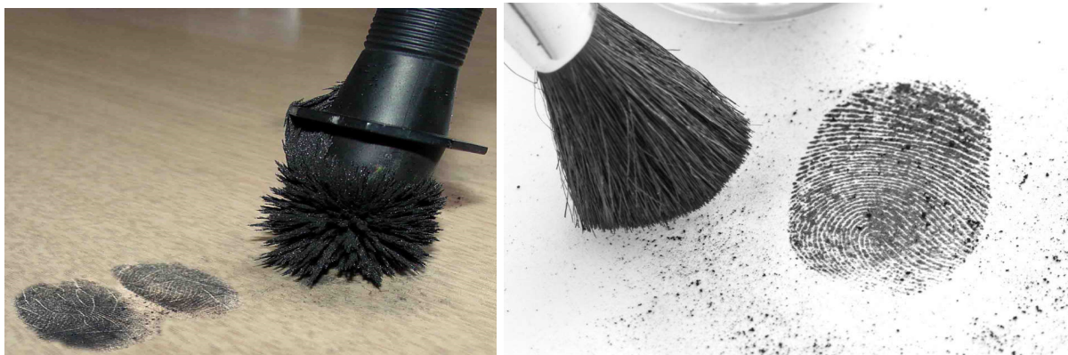
Рис. 6.6. Выявление следов с помощью магнитной кисти
