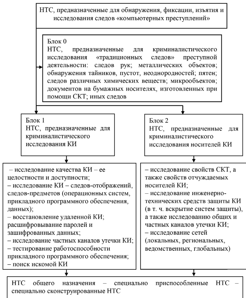
Рис. 1. Обобщенная структура НТС, необходимых для обнаружения, фиксации, изъятия и исследования следов «компьютерных преступлений»
