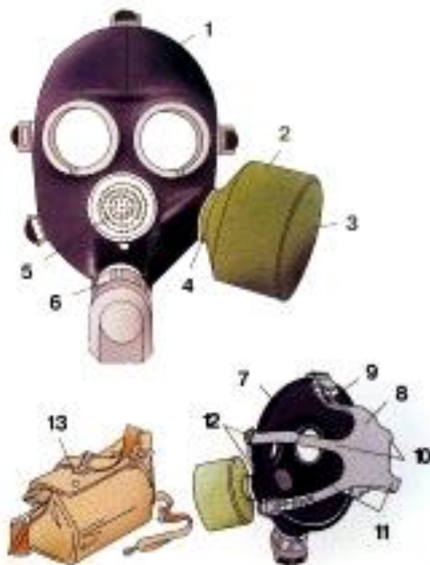
Рисунок 2. Структура противогаза ГП-7 [16]
