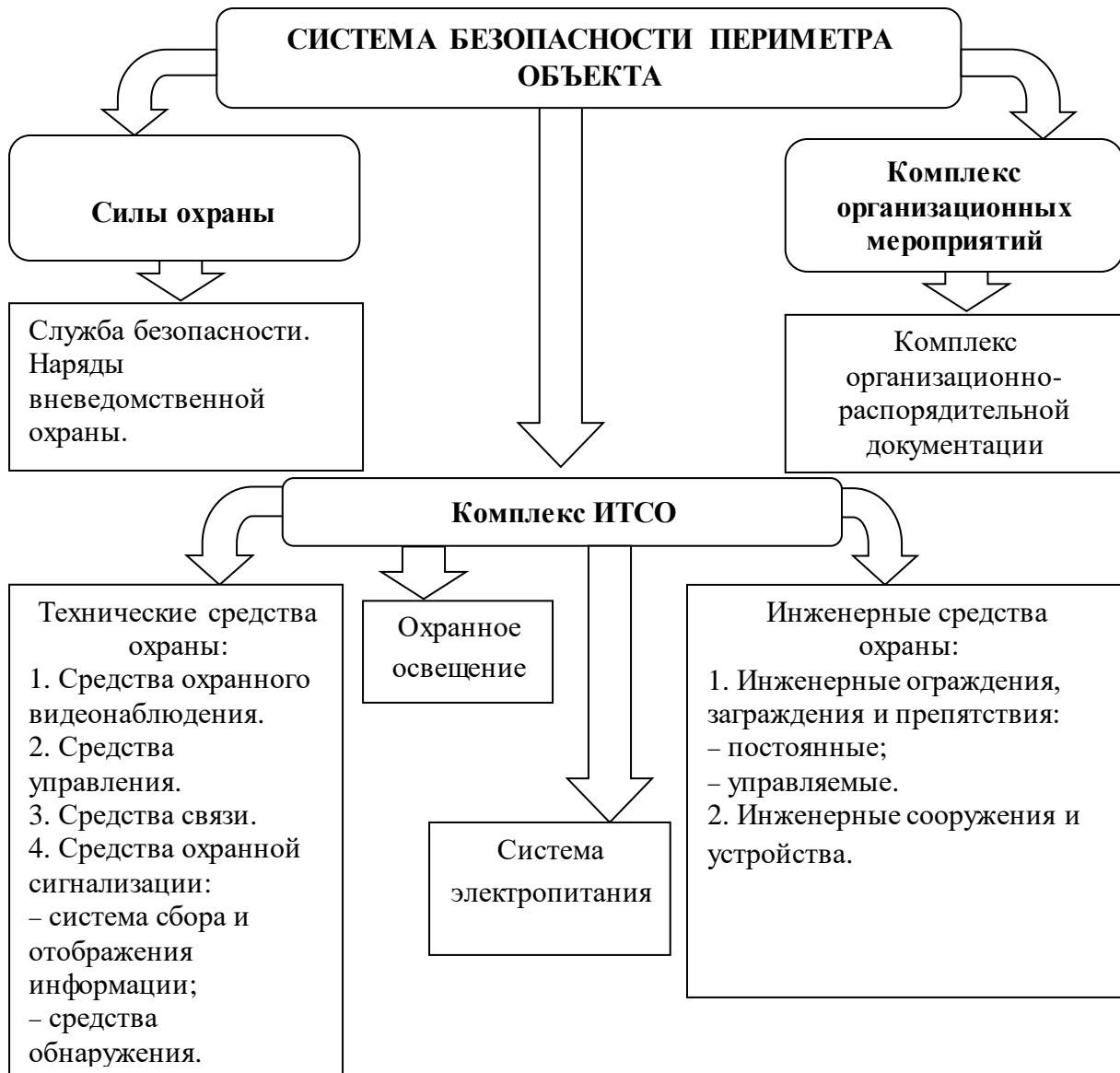
Рис. 1.4. Состав системы охраны периметра объекта
