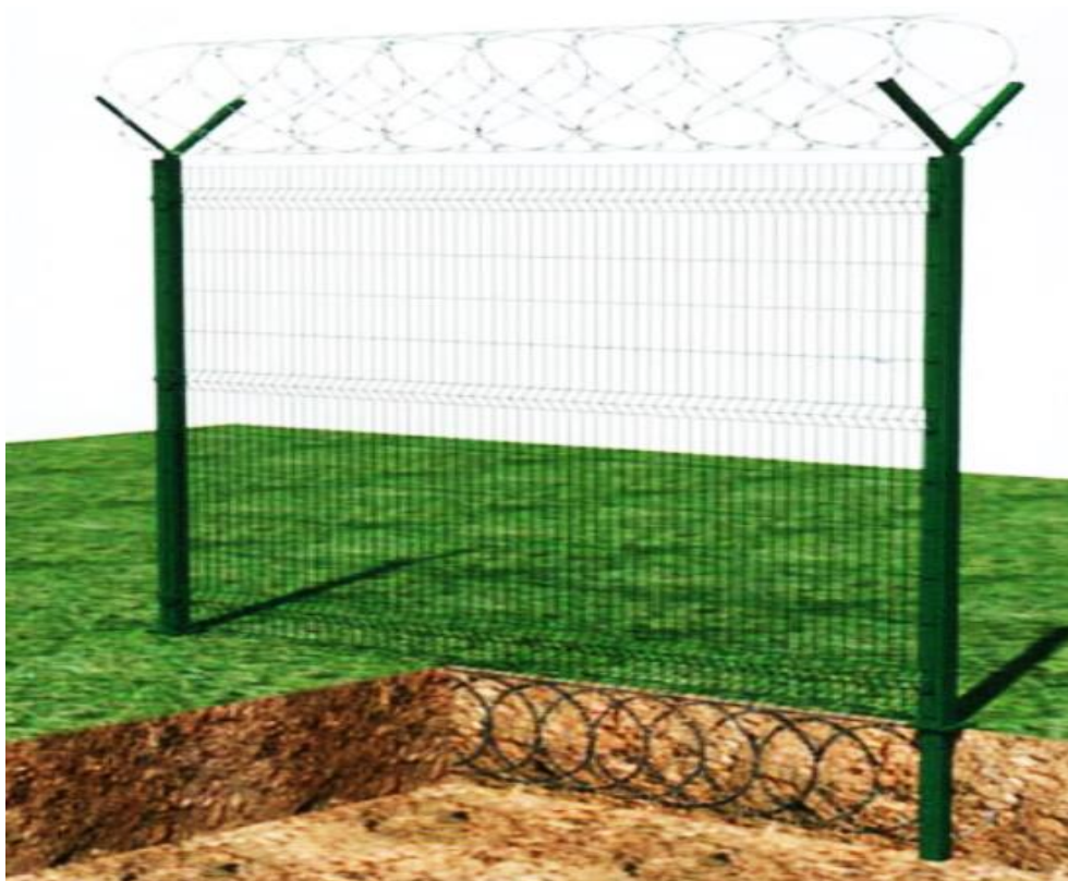
Рис. 1.17. Нижнее дополнительное ограждение в виде барьера безопасности
