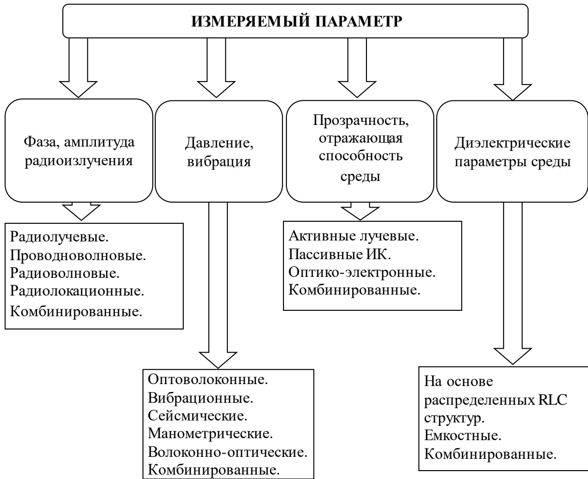
Рис. 1.5. Классификация периметральных систем охраны по виду регистрируемого воздействия
