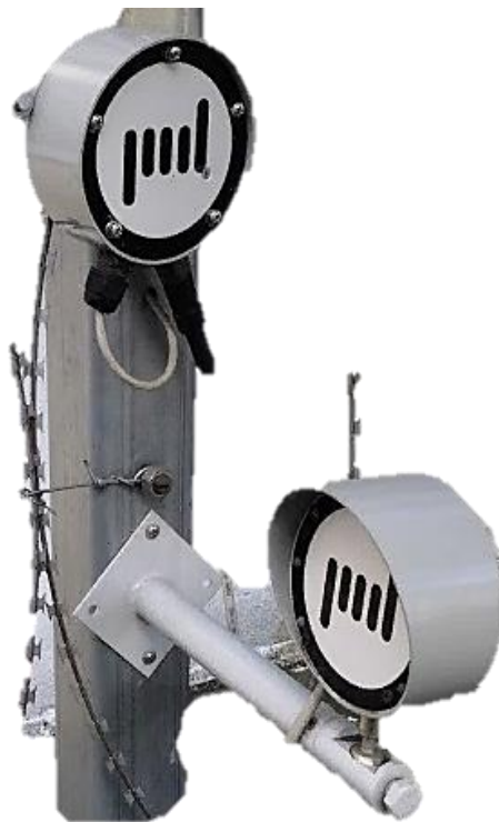
Рис. 4.3. Внешний вид радиоволнового извещателя «Призма-3-10/100МР»
