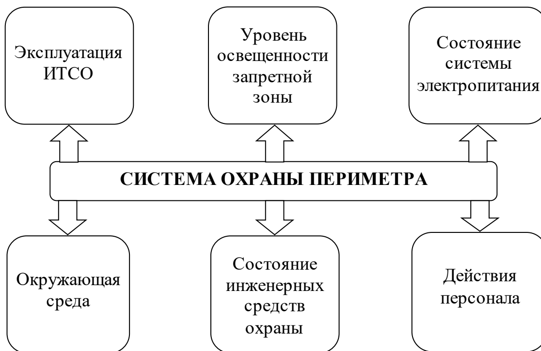
Рис. 2.2. Факторы, влияющие на эффективность системы охраны периметра
