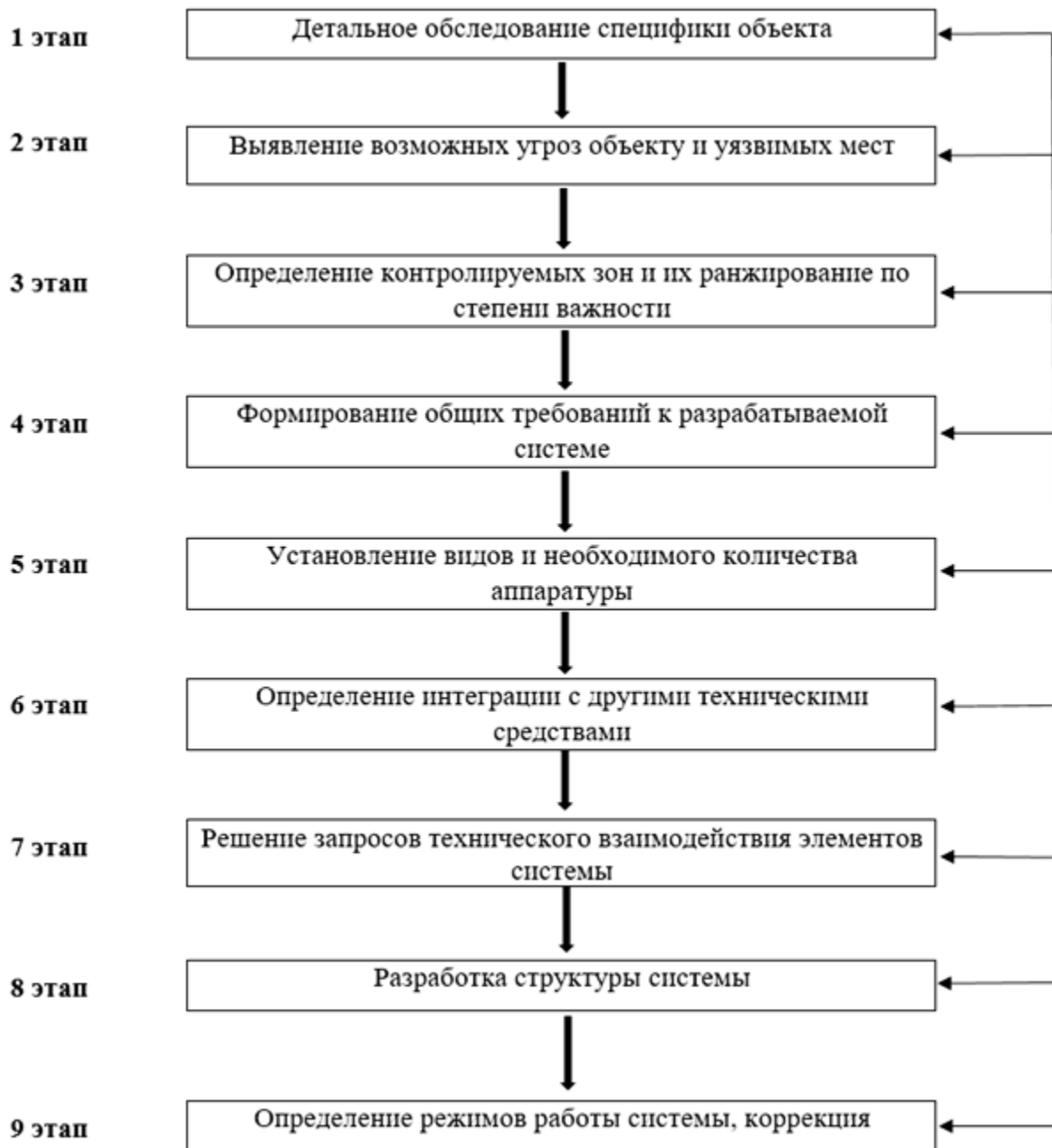
Рис. 2.3. Обобщенный тактический алгоритм разработки системы видеонаблюдения
