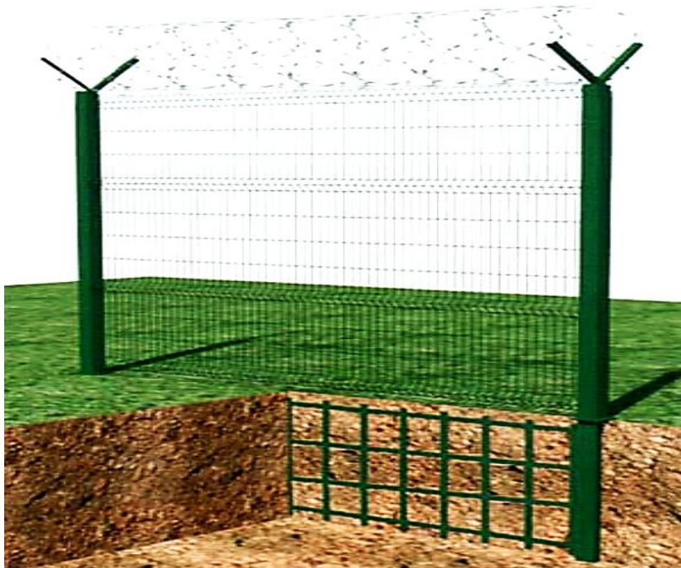
Рис. 1.15. Нижнее дополнительное ограждение в виде сварной решётки
