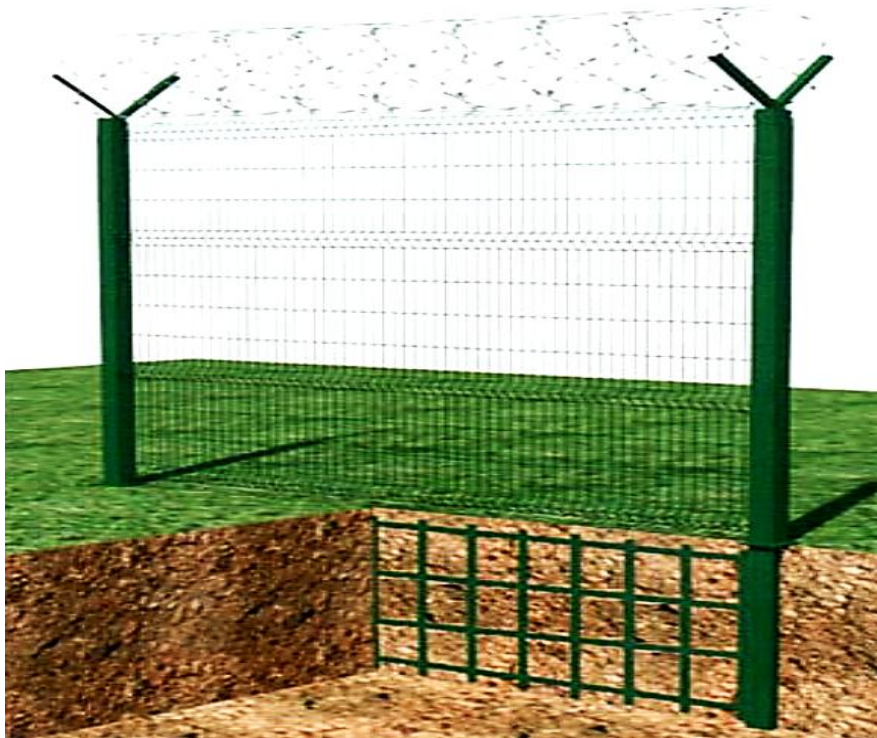
Рис. 3.9. Нижнее дополнительное ограждение в виде сварной решётки
