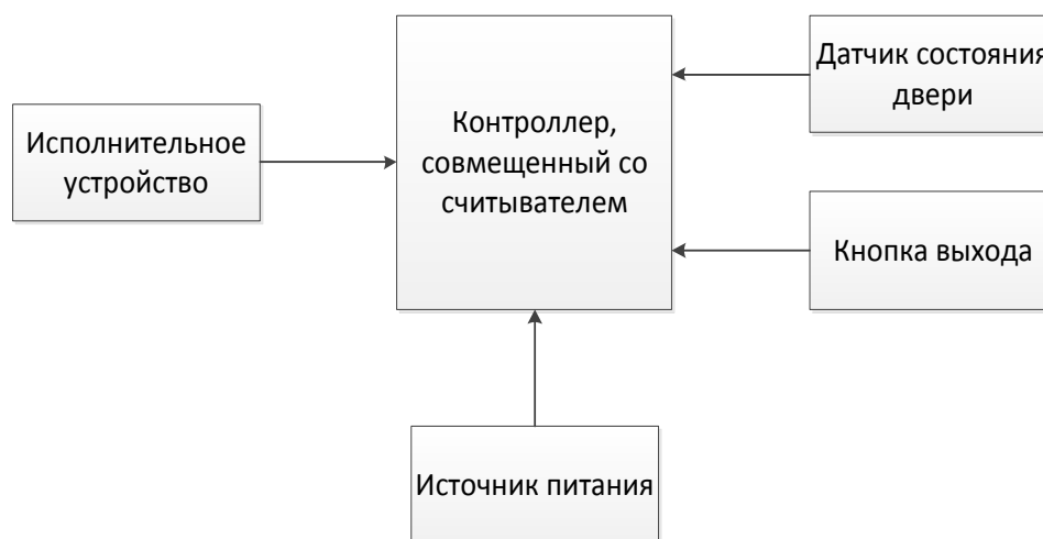
Рис. 2.2. Структурная схема варианта автономной СКУД в помещении с одной дверью
