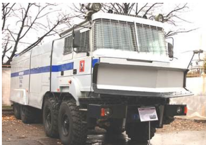
Рис. 12. Специальный автомобиль с водометной установкой для пресечения массовых беспорядков, применяемый в составе группы разграждения
