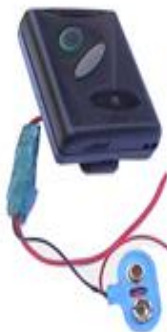
Взрыватель замедленного действия, выполненный на основе электронных часов «Casio»
