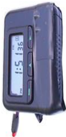
Взрыватель замедленного действия, выполненный на основе электронного будильника
