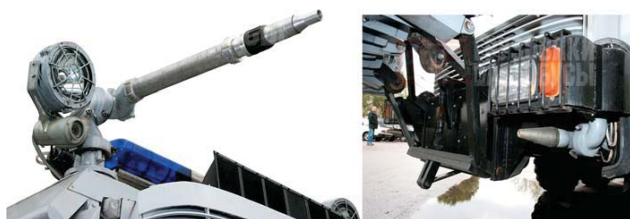
Рисунок 60. Водометные стволы: основной – лафетный, соединенный с прожектором и видеокамерой (на крыше), и вспомогательный (под бампером)
