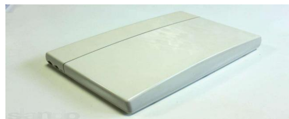
Рисунок 107. Цифровой уплотнитель телефонной линии «Telspec Telmax IRU 4»
