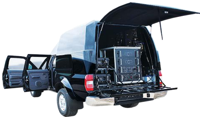
Рисунок 14. Пелена-14Т автомобильный комплекс блокираторов взрывных устройств и сотовых телефонов
