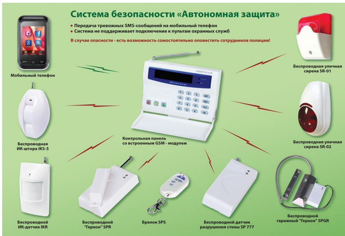
Рисунок 109. Типовая автономная система охраны объекта
