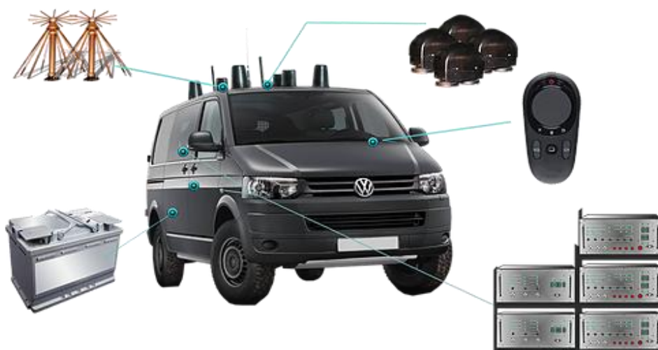
Рисунок 15. Пелена-1000 автомобильный комплекс блокираторов взрывных устройств и сотовых телефонов
