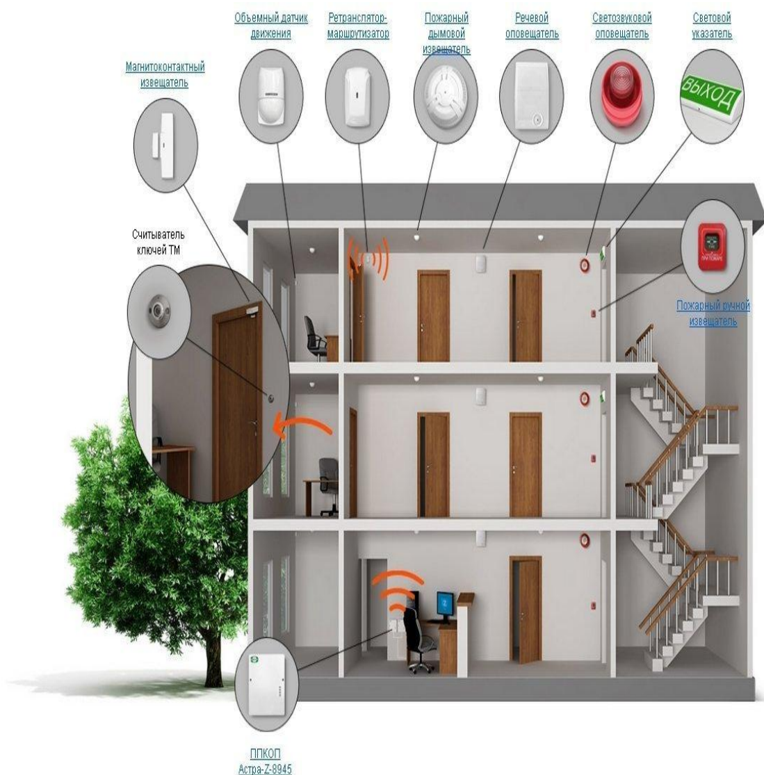
Рисунок 110. Схема комплекса беспроводной сигнализации «Астра-Zumадель»
