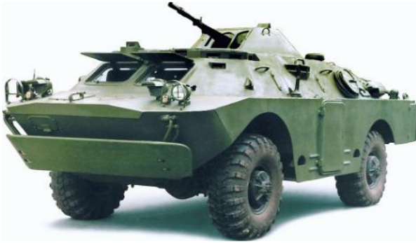
Рисунок 80. Бронированная разведывательно-дозорная машина БРДМ-2
