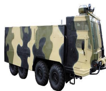
Рисунок 77. Водометный спецавтомобиль ABC-40
