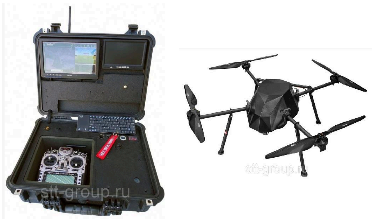
Рис. 4.11. Нелинейный локатор, размещенный на беспилотном летательном аппарате «Стрекоза»
