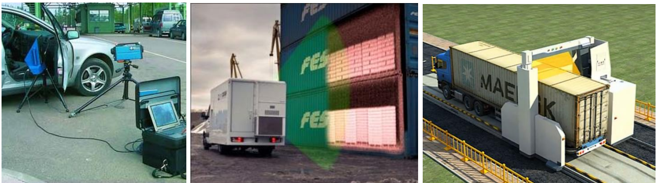
Рис. 4.13. Рентгеновские телевизионные установки: портативная (слева), мобильная с технологией ОРПИ (в центре), стационарная (справа)
