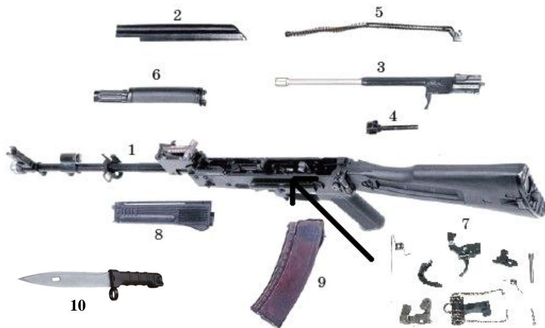
Рис. 71. Основные части и механизмы автомата Калашникова
