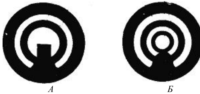
Рис. 87. Диоптрические прицелы: А – с пеньковой мушкой; Б – с кольцевой мушкой
