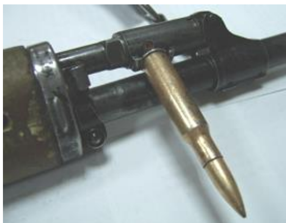
Рис. 61. Перестановка газового регулятора
