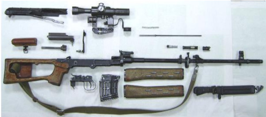
Рис. 58. Основные части снайперской винтовки Драгунова
