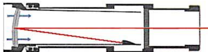
Рис. 91. Схема действия коллиматорного прицела
