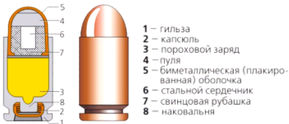
Рис. 45. Общий вид и устройство 9-мм пистолетного патрона
