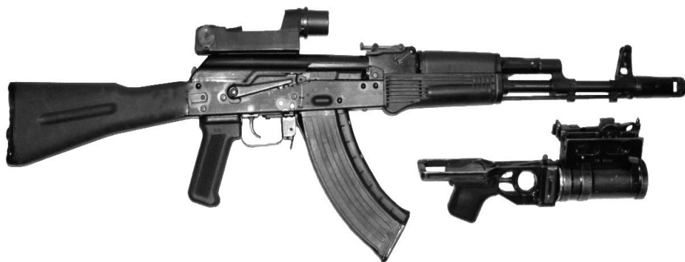
Рис. 5. Автомат Калашникова АКС-74М калибра 5,45-мм, оснащенный складывающимся прикладом и устройством для присоединения оптического прицела и прицела ночного видения. Возможно дополнительное оборудование подствольным гранатометом ГП-25
