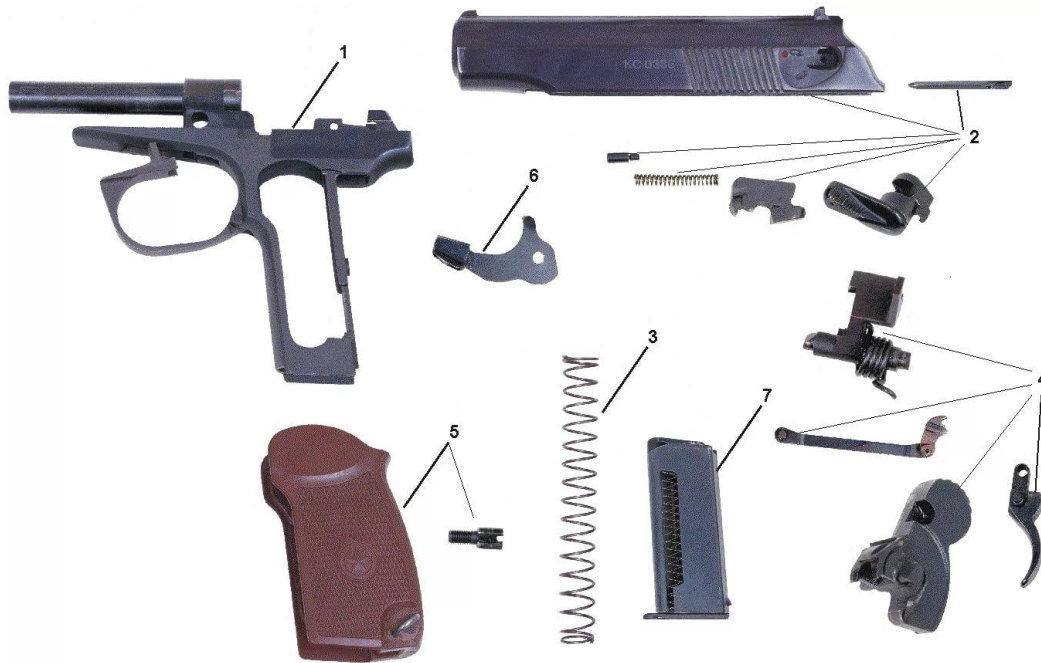
Рис. 28. Основные части и механизмы пистолета: 1 – рамка со стволом и спусковой скобой, 2 – затвор с ударником, выбрасывателем и предохранителем, 3 – затворная задержка, 4 – ударно-спусковой механизм, 5 – возвратная пружина, 6 – магазин, 7 – рукоятка с винтом
