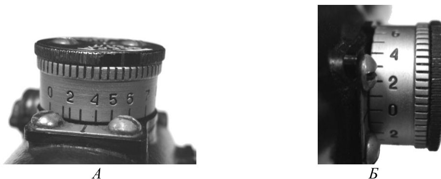
Рис. 103. Верхний и боковой маховики для регулировки оптического прицела ПСО-1: А – верхний маховик; Б – боковой маховик
