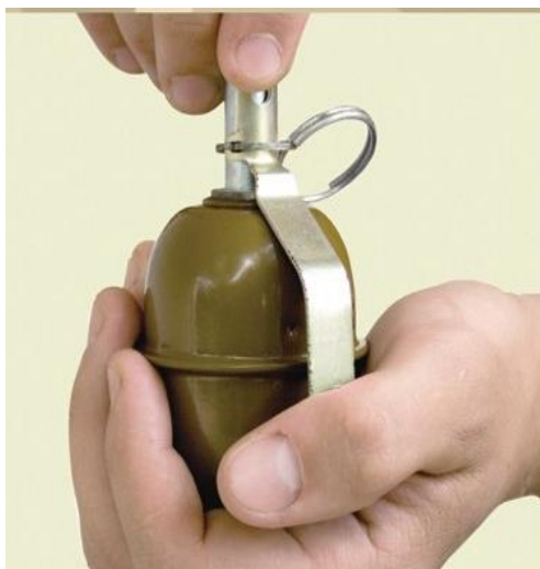
Рис. 82. Ввинчивание запала гранаты
