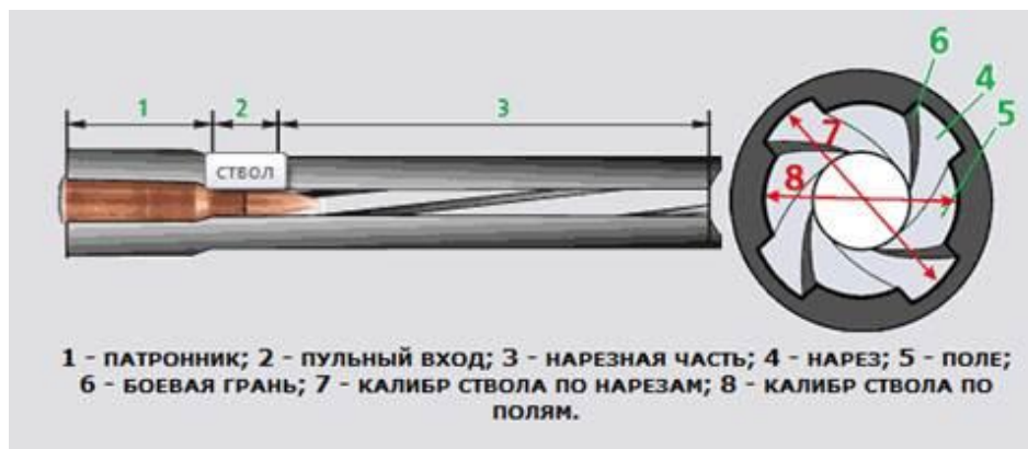
Рис. 15. Сечение канала ствола автомата
