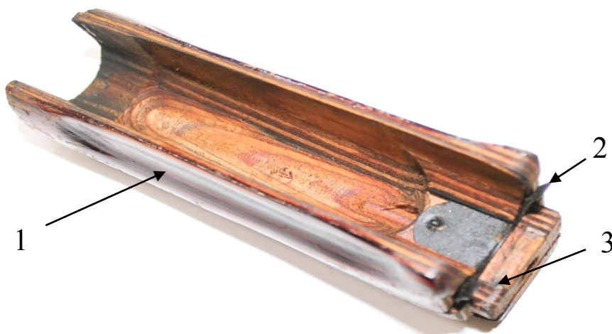
Фото 44. Цевье (деревянное): 1 – упор для пальцев; 2 – пластинчатая пружина; 3 – выступ
