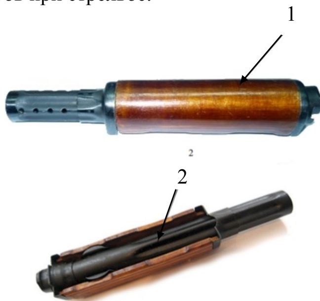
Фото 31. Газовая трубка со ствольной накладкой: 1 – ствольная накладка; 2 – газовая трубка
