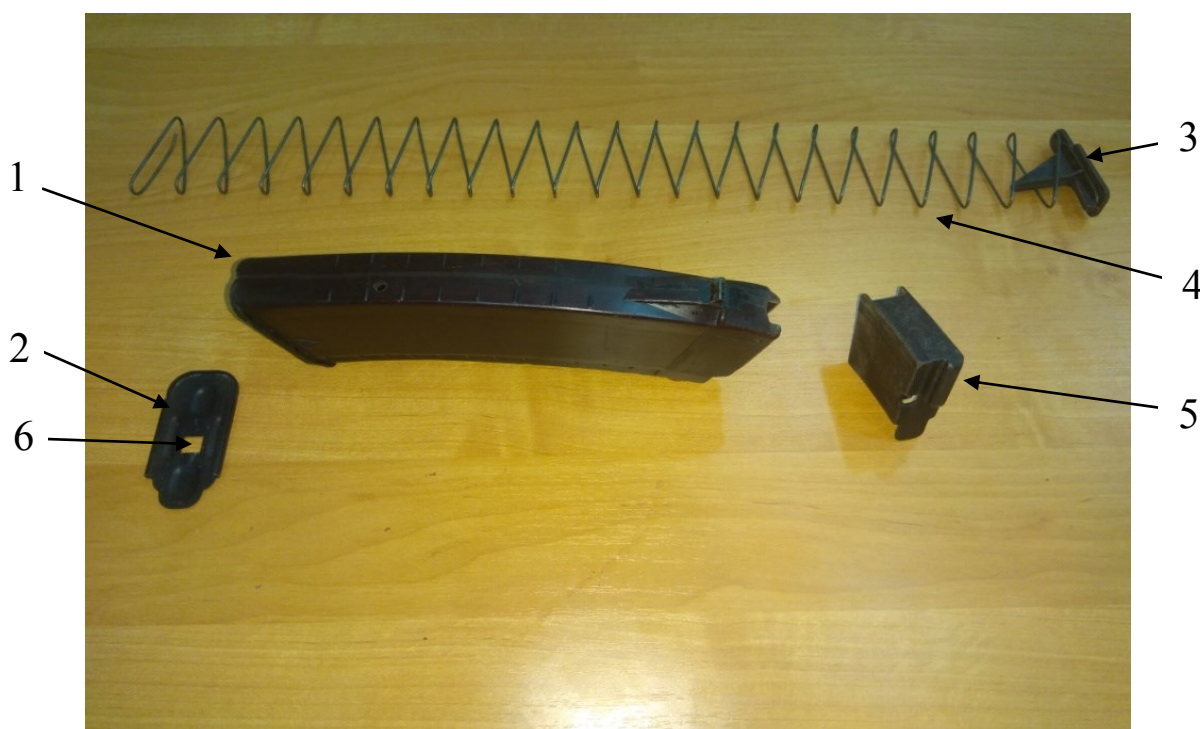
Фото 34. Магазин: 1 – корпус магазина; 2 – крышка магазина; 3 – стопорная планка; 4 – пружина; 5 – подаватель; 6 – отверстие для выступа стопорной планки
