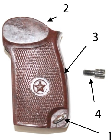
Фото 17. Рукоятка с винтом: 1 – антабка; 2 – пазы; 3 – отверстие; 4 – винт
