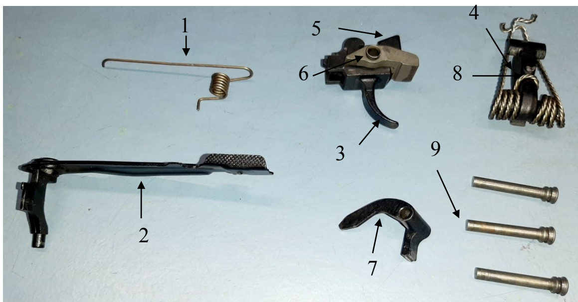
Фото 38. Части ударно-спускового механизма АКС-74У: 1 – пружина автоспуска; 2 – переводчик; 3 – спусковой крючок; 4 – ограничитель поворота курка; 5 – шептало одиночного огня с пружиной, 6 – трубчатая ось; 7 – автоспуск; 8 – курок с боевой пружиной; 9 – оси
