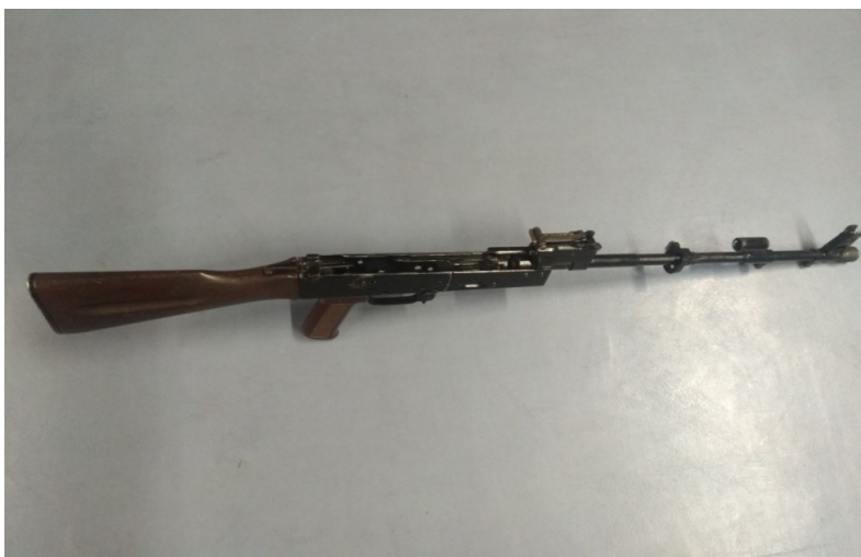
Фото 22. Ствол со ствольной коробкой, прицельным приспособлением, прикладом и пистолетной рукояткой АК-74
