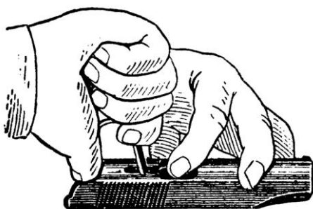
Рисунок 3.12. – Отделение выбрасывателя от затвора
