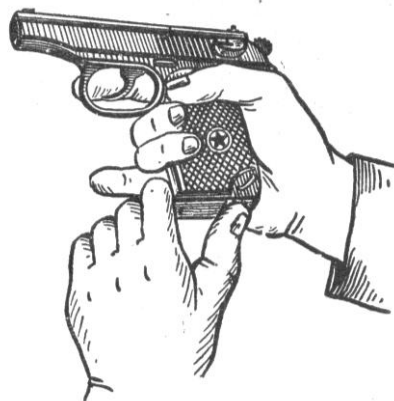
Рисунок 3.3. – Извлечение магазина из основания рукоятки
