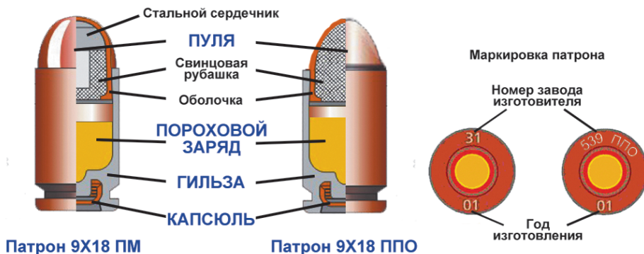
Рис. 57. Общий вид 9-мм пистолетного патрона и его устройство
