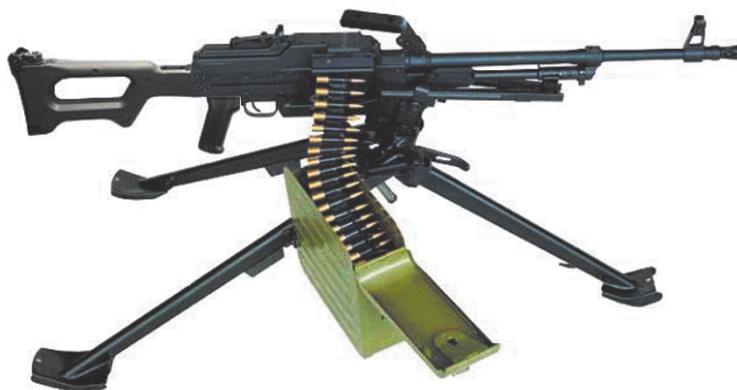
Рис. 32. 7,62-мм пулемет Калашникова ПКМ
