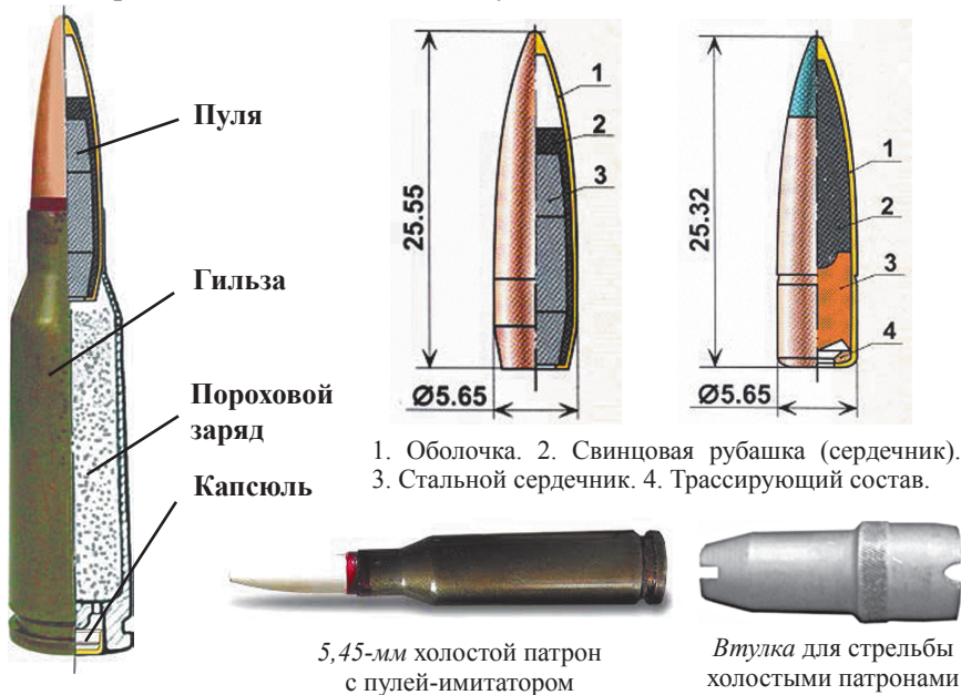
Рис. 96. Патроны для автомата
