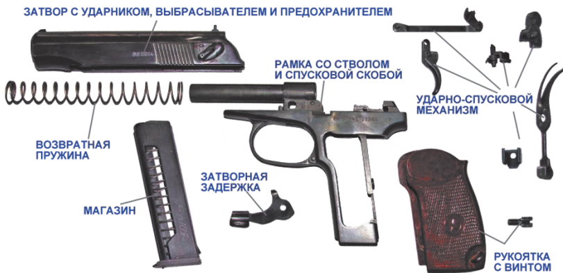
Рис. 58. Основные части и механизмы пистолета
