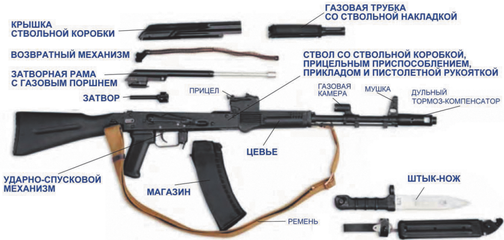
Рис. 77. Основные части и механизмы автомата (АК74)
