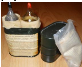
Рис. 53. Комплект индивидуального дегазационного пакета ИДП-С
