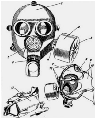
Рис. 1. Фильтрующий противогаз ГП-7: 1 – лицевая часть; 2 – фильтрующе-поглощающая коробка; 3 – трикотажный чехол; 4 – узел клапана вдоха; 5 – переговорное устройство (мембрана); 6 – узел клапана выдоха; 7 – обтюратор; 8 – изголовник (затылочная пластина); 9 – лобная лямка; 10 – височные лямки; 11 – щечные лямки; 12 – пряжки; 13 – сумка противогаза
