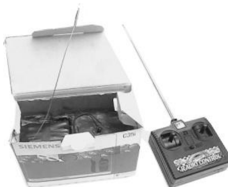
Рисунок 44 – СВУ радиоуправляемое, в качестве радиовзрывателя используются приемно-передающее устройство и элементы питания
