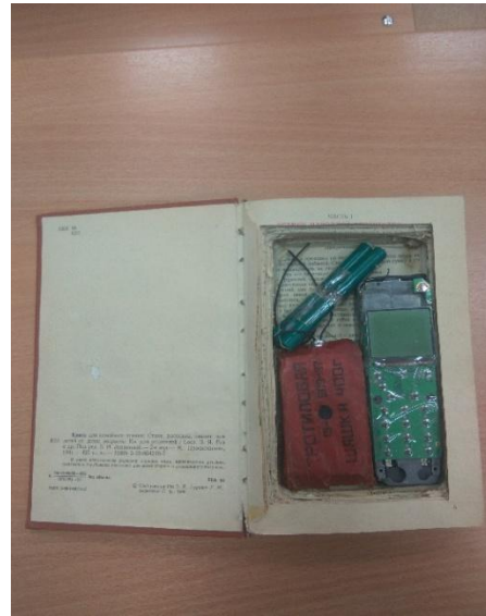
Рисунок 39 – СВУ радиоуправляемое, в качестве радиовзрывателя используются сотовый телефон, элементы питания и электродетонатор
