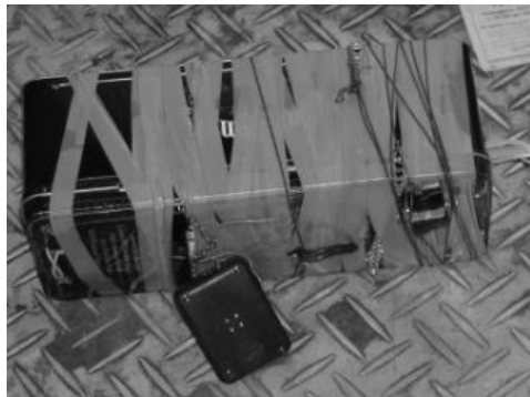
Рисунок 40 – СВУ с часовым взрывателем, изготовленным из бытового электронного таймера
