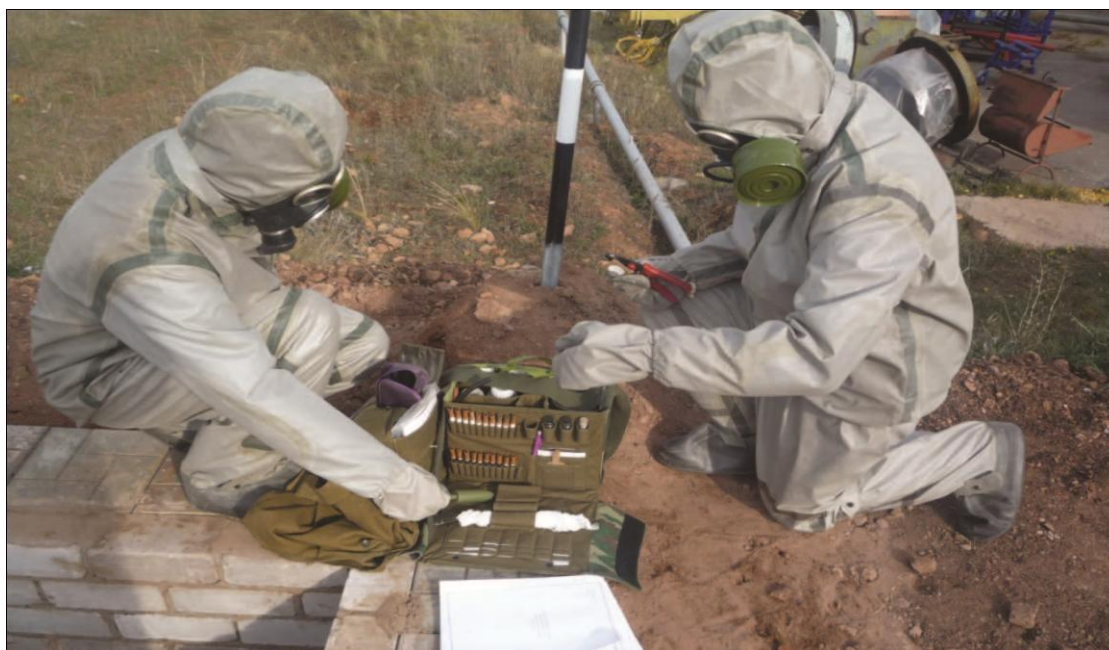
Рисунок 20 – Пост радиационного химического наблюдения отбирает пробы на местности с помощью КПО-1М
