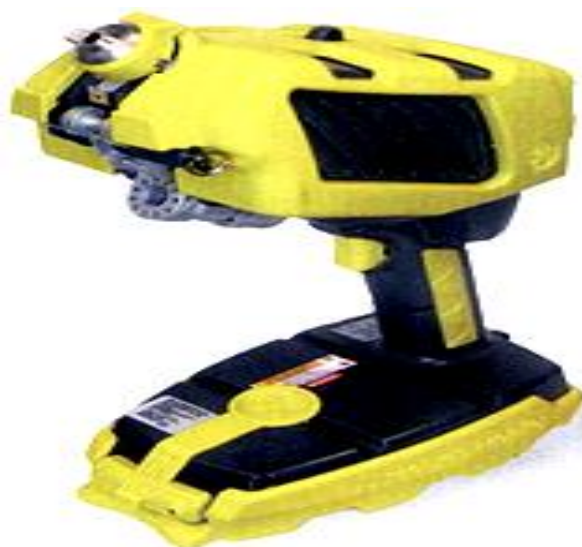
Фото 12. Портативная система идентификации химически и биологически опасных веществ в полевых условиях «StreetLab®Mobile»
