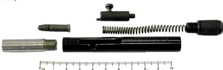
Рис. 60. Самодельное стреляющее устройство в разобранном виде
