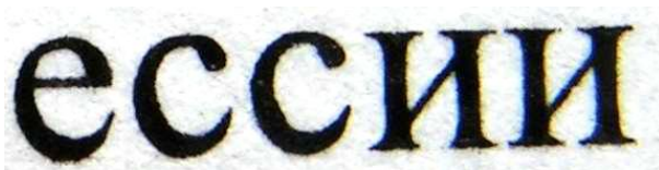
Рис. 101. Увеличенное изображение текста, полученного электрофотографическим способом
