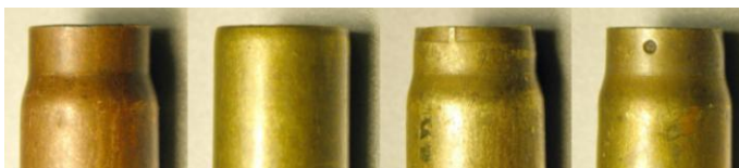
Рис. 65. Способы крепления пули с гильзой
