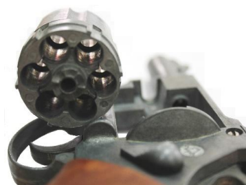
Рис. 54, 55. Револьвер и барабан, выполняющий функцию магазина
