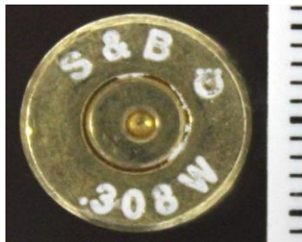
Рис. 21. Полученное изображение донца гильзы с маркировочными обозначениями
