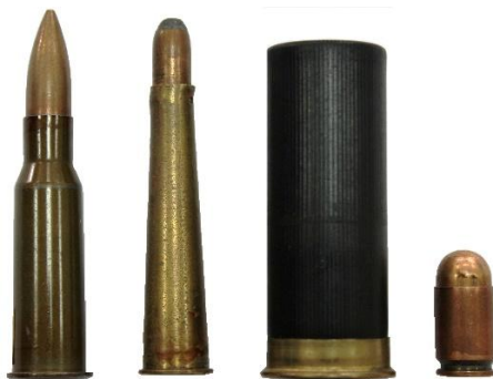
Рис. 71. Форма гильз (слева направо: бутылочная, коническая, цилиндрические)
