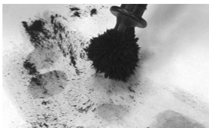
Рис. 31. Рабочая часть магнитной кисти, сформированная из порошка
