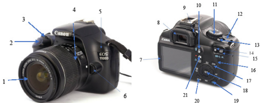
Рис. 9. Устройство цифрового зеркального фотоаппарата CANON 1100 D:
