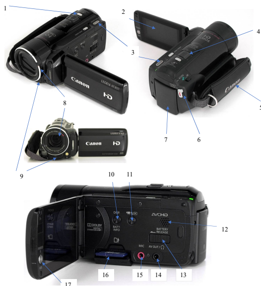
Рис. 12. Устройство цифровой видеокамеры Canon Legria HF M31: 1 — кнопка PHOTO; 2 — сенсорный экран ЖК-дисплея; 3 — кнопка POWER; 4 — рычаг зумирования; 5 — ручка; 6 — кнопка START/STOP; 7 — блок крепления аккумулятора; 8 — объектив; 9 — стереомикрофон; 10 — кнопка DISP (индикация на экране); 11 — кнопка камера/воспроизведения; 12 — динамик; 13 — переключатель BATTERY RELEASE; 14 — разъем AVOUT; 15 — микрофонный разъем; 16 — гнездо карты памяти; 17 — кнопка POWERED IS
