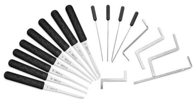
Рис. 94. Инструменты для манипуляционного подбора кода замка
