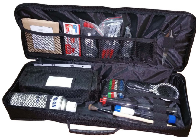
Рис. 3. Унифицированный дактилоскопический набор «Дакто», предназначенный для обнаружения следов пальцев, ладоней рук для последующего проведения исследований, а также обязательного и добровольного дактилоскопирования живых лиц. Комплект чемодана: разные виды дактилоскопических порошков; кистей; дактилоскопическая краска; валик; стекло для раскатки краски; дактилокарты и др.
