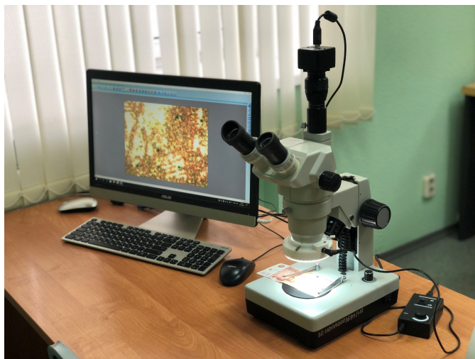
Рис. 4. Микроскоп МБС-10, содержащий штатив с механизмом фокусировки, систему визуализации в виде бинокулярной или тринокулярной насадки с окулярами, оптическую систему формирования изображения, отличающийся тем, что система формирования изображения представляет собой двоянный объектив, состоящий из двух одинаковых оптических систем, каждая из которых формирует изображение объекта независимо от другой
