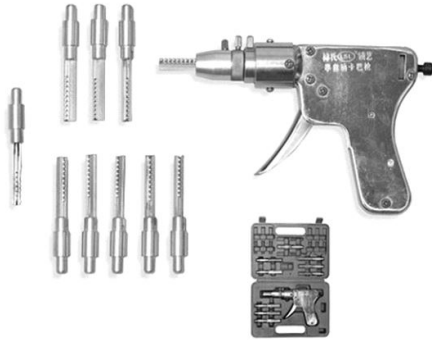
Рис. 99. Вибропистолет с набором инструментов и приспособлений, используемых при бампинг-методе
