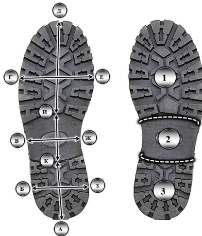
Рис. 47. Части подошвы обуви (справа) и измерение ее отдельных частей (слева): АД — общая длина; ДИ — длина подметочной части; GE — ширина подметочной части; ИК — длина промежуточной части; ВЖ — ширина промежуточной части; АК — длина каблучной части; БЗ — ширина каблучной части; 1 — подметочная часть; 2 — промежуточная часть; 3 — каблучная часть
