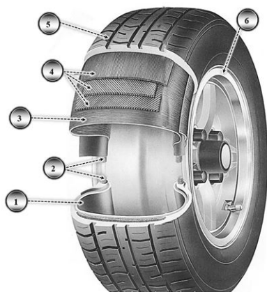
Рис. 65. Конструкция колеса автомобиля: 1 — внутренний слой шины; 2 — прижимная проволока; 3 — корпус шины; 4 — усиливающие прокладки; 5 — протектор; 6 — диск
