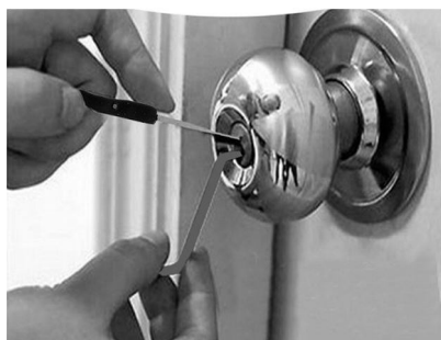
Рис. 95. Пример манипуляционного воздействия на механизм замка
