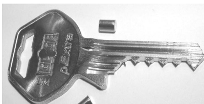
Рис. 97. Ключевая заготовка с максимальными типоразмерами для бампинга
