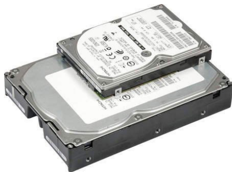
Рис. 178. Общий вид НЖМД форм-фактора 2,5 дюйма (верхний) и 3,5 дюйма (нижний)
