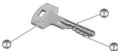
Рис. 92. Элементы ключа: 1 — головка ключа; 2 — стержень; 3 — бородка
