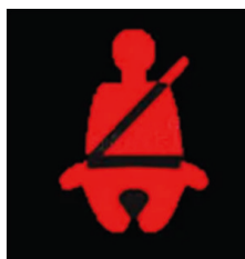
Рисунок 26 – Индикатор напоминания о непристегнутом ремне безопасности
