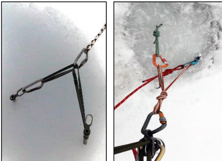
*Организация станций различными способами: при помощи двух ледобуров и ледовой проушины (петля Абалакова)*
