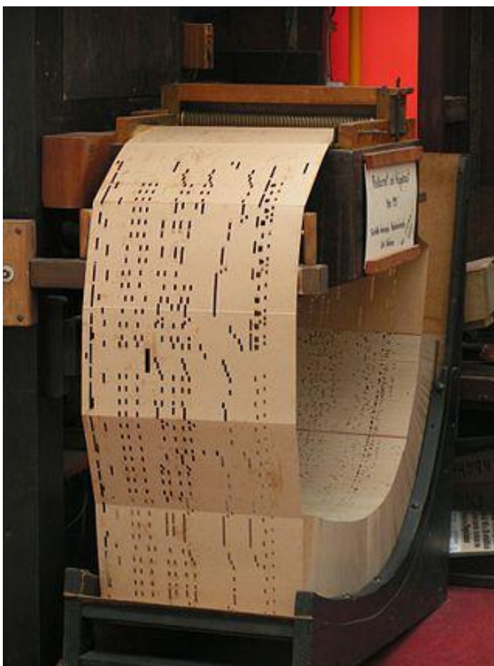
Рис. 9. Перфокарточная система музыкального автомата
