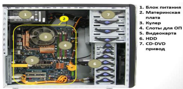
Рисунок 4. – Основные внутренние устройства системного блока
