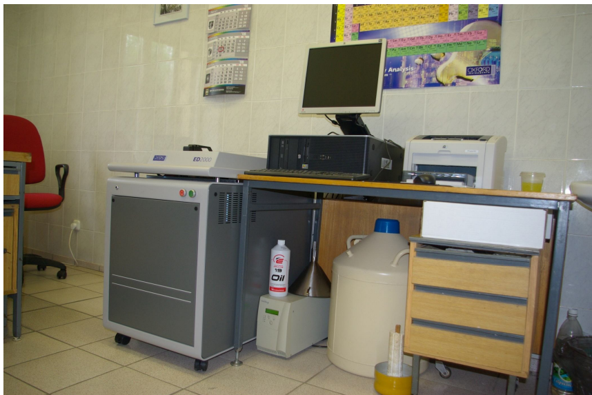
Рис. 1. Рентгенофлуоресцентный анализатор OXFORD ED-2000 (Великобритания)
