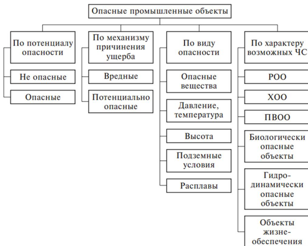
Рис. 2. Классификация опасных промышленных объектов.
