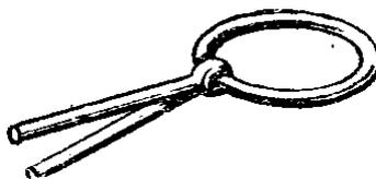
Рис. 8. Предохранительная чека с кольцом
