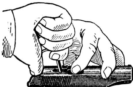
Рис.3.12. Отделение выбрасывателя от затвора
