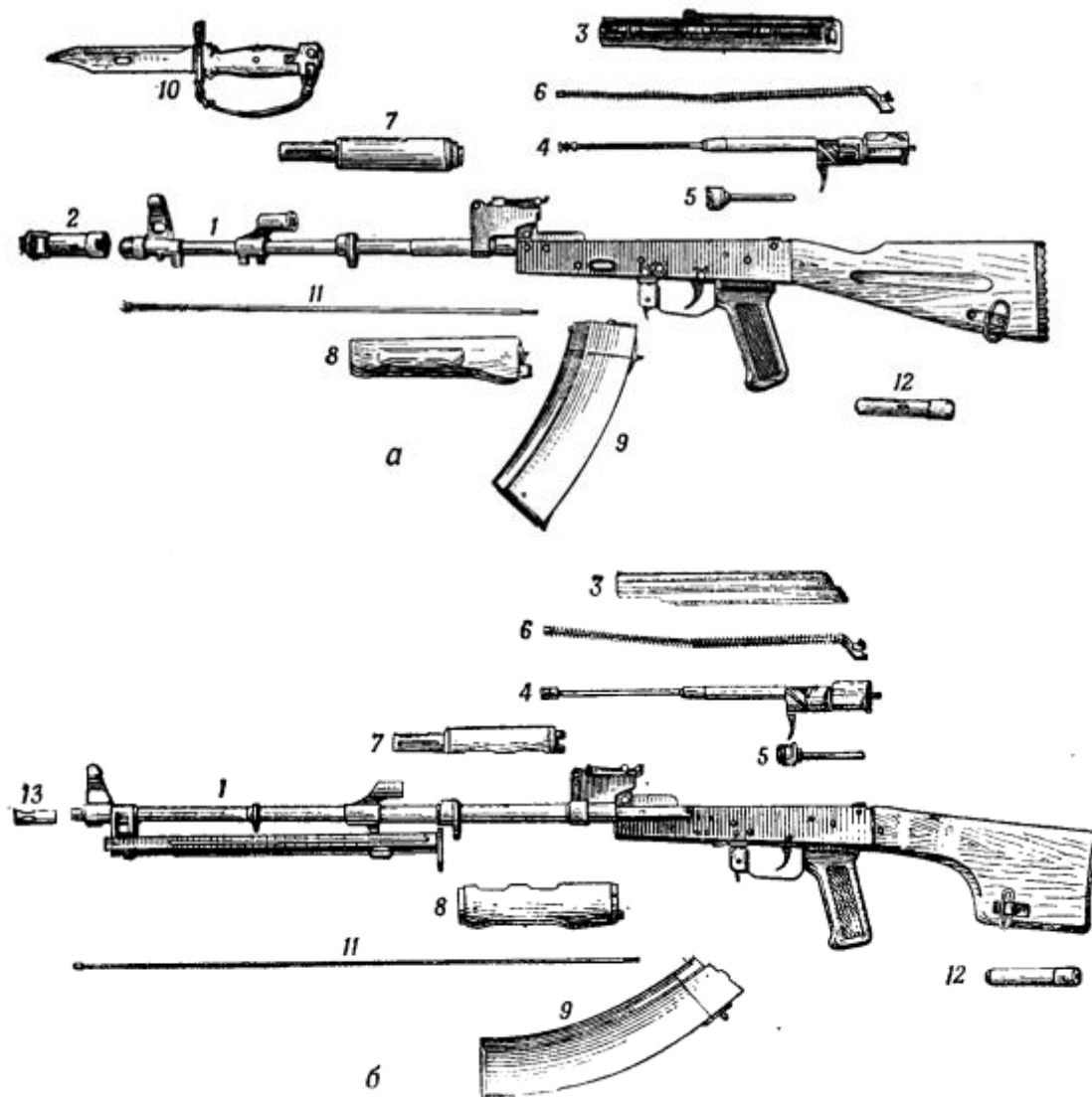
Рис. 3.42. Устройство а) 5,45-мм автомата Калашникова (АК-74), б) ручного пулемета Калашникова (РПК):
