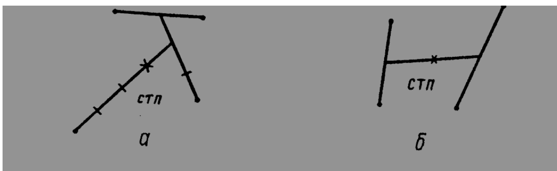
Рис. 3.39. Определение СТП по четырем пробоинам.
