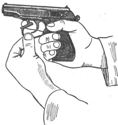
Рис.3.4. Оттягивание спусковой скобы
