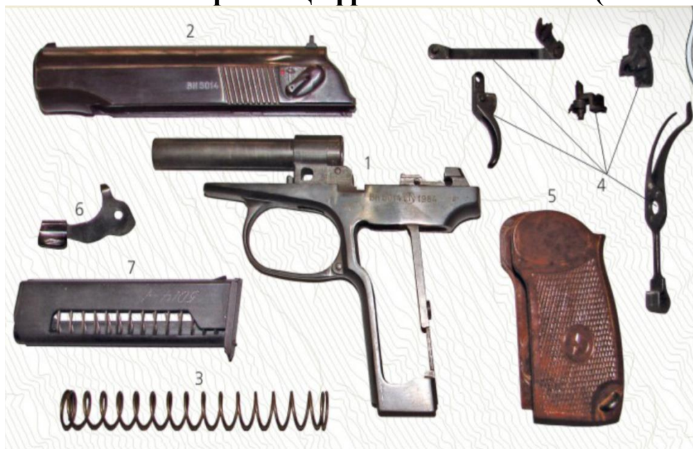
Рисунок 61 – 7 составных частей пистолета Макарова
