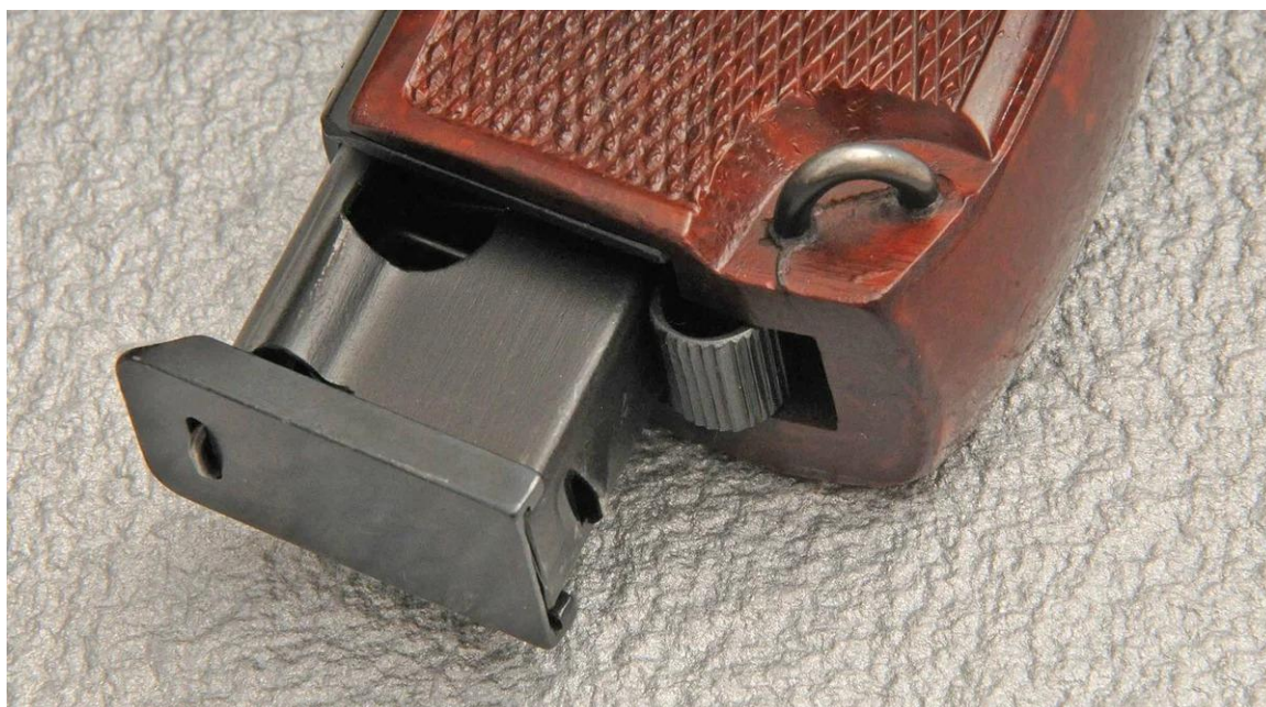
Рисунок 56 – Магазин пистолета Макарова в полуизвлеченном состоянии
