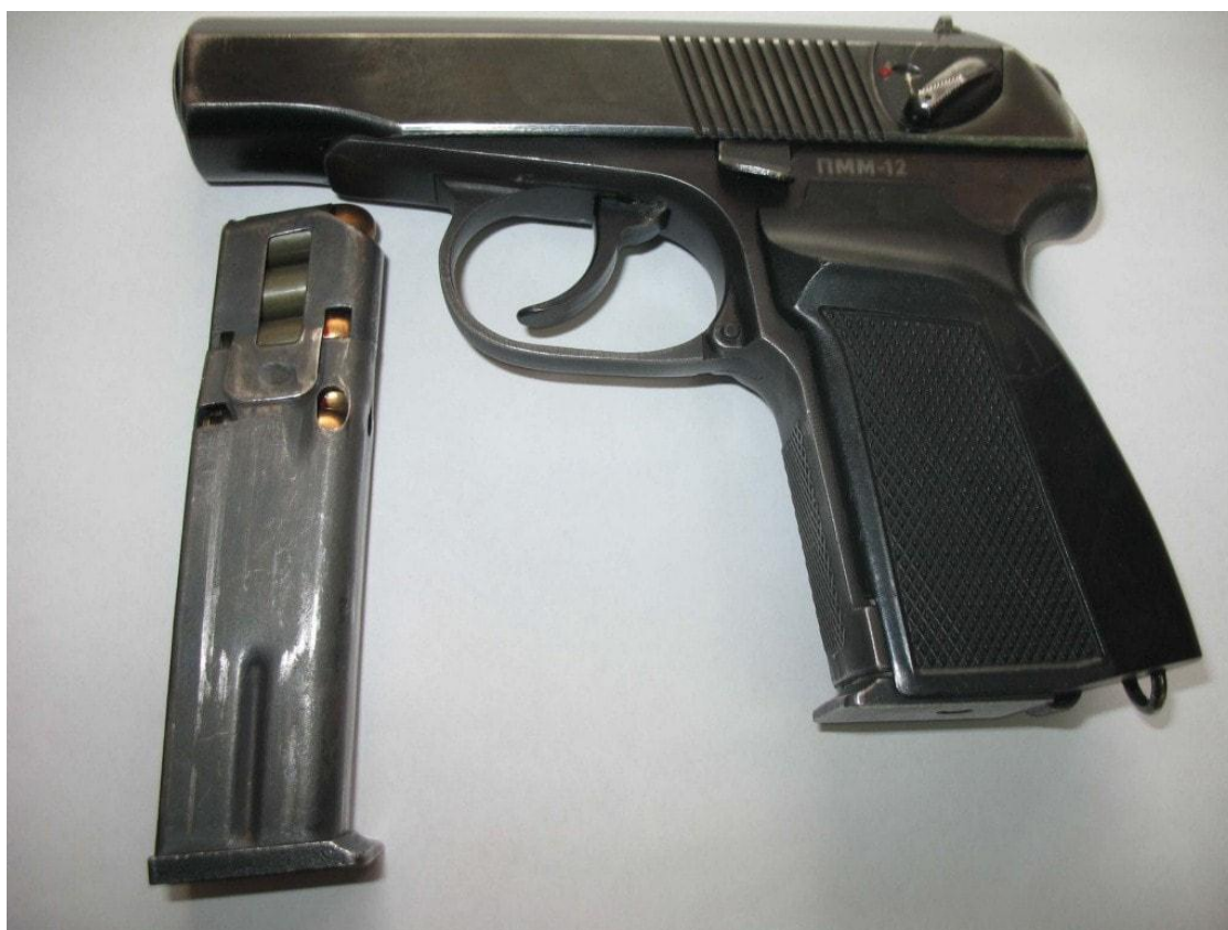
Рисунок 48 – ПМ (модернизированный) (ПММ-12) калибра 9-мм, состоящий на вооружении с 1994 г., с двухрядным магазином на 12 патронов
