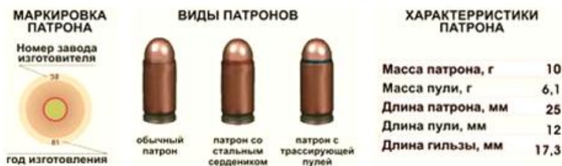
Рисунок 64 – Основные виды 9-мм патронов для пистолета Макарова
