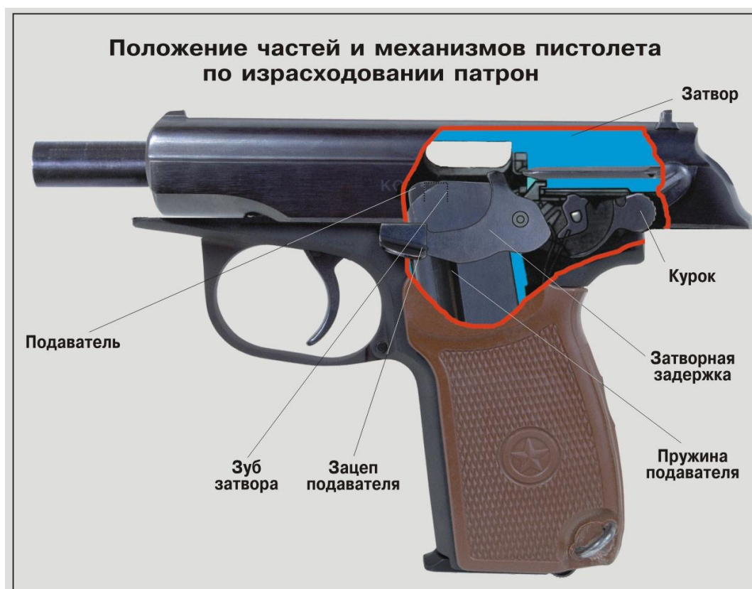
Рисунок 59 – Положение частей и механизмов пистолета по израсходовании патронов
