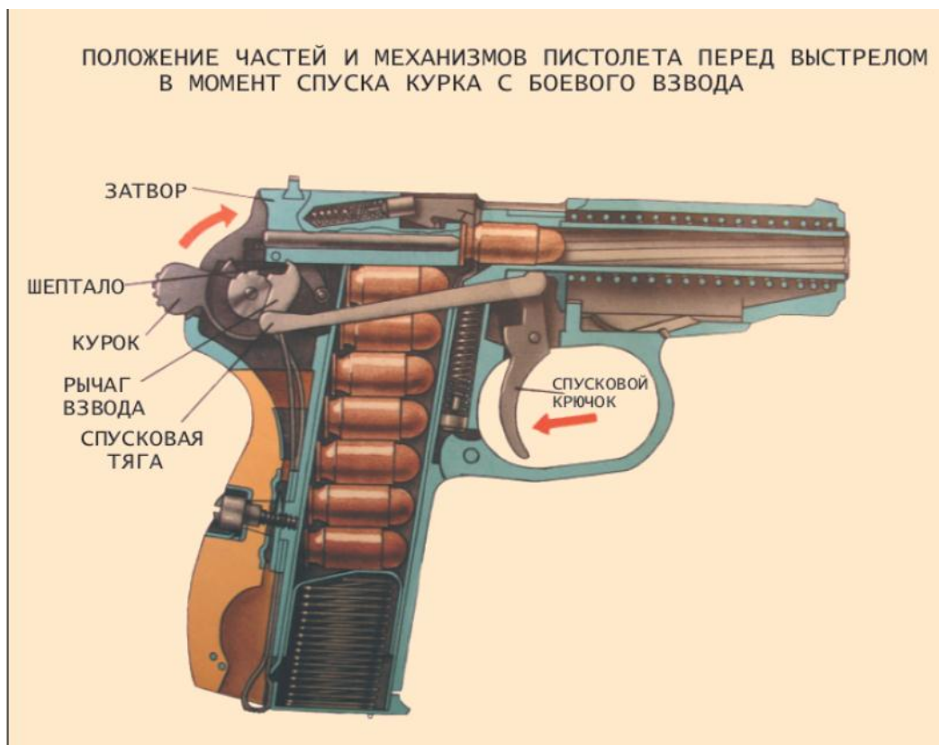
Рисунок 58 – Положение частей и механизмов пистолета в момент спуска курка с боевого взвода
