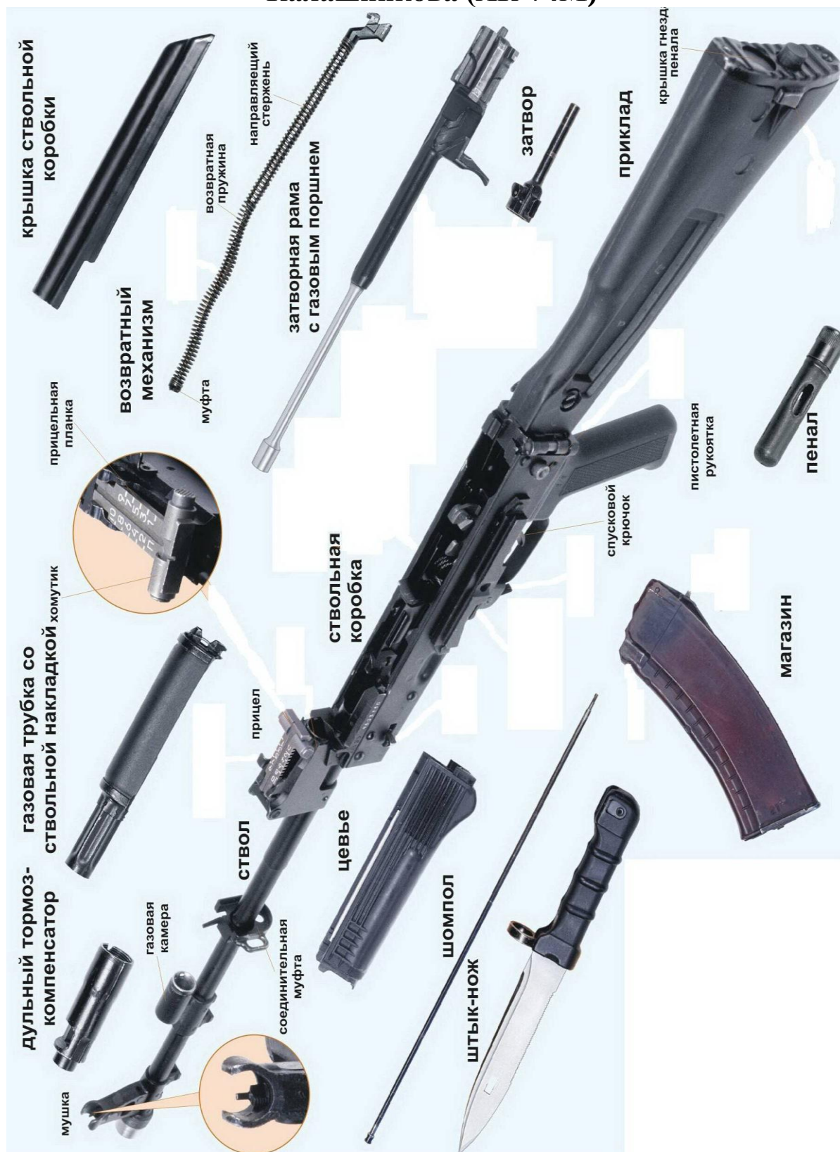
Рисунок 71 – Составные части и принадлежность 5,45-мм автомата АК-74М
