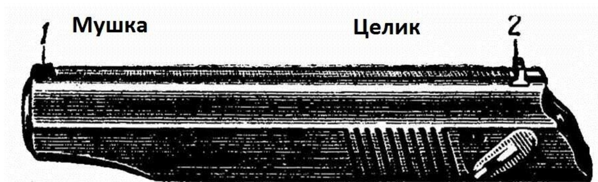
Рисунок 23 – Расположение целика и мушки на затворе пистолета Макарова
