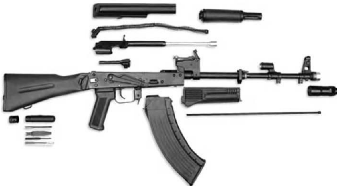
Рисунок 70 – Неполная разборка (с отделением цевья, прим. автора) 5,45-мм автомата АК-74М
