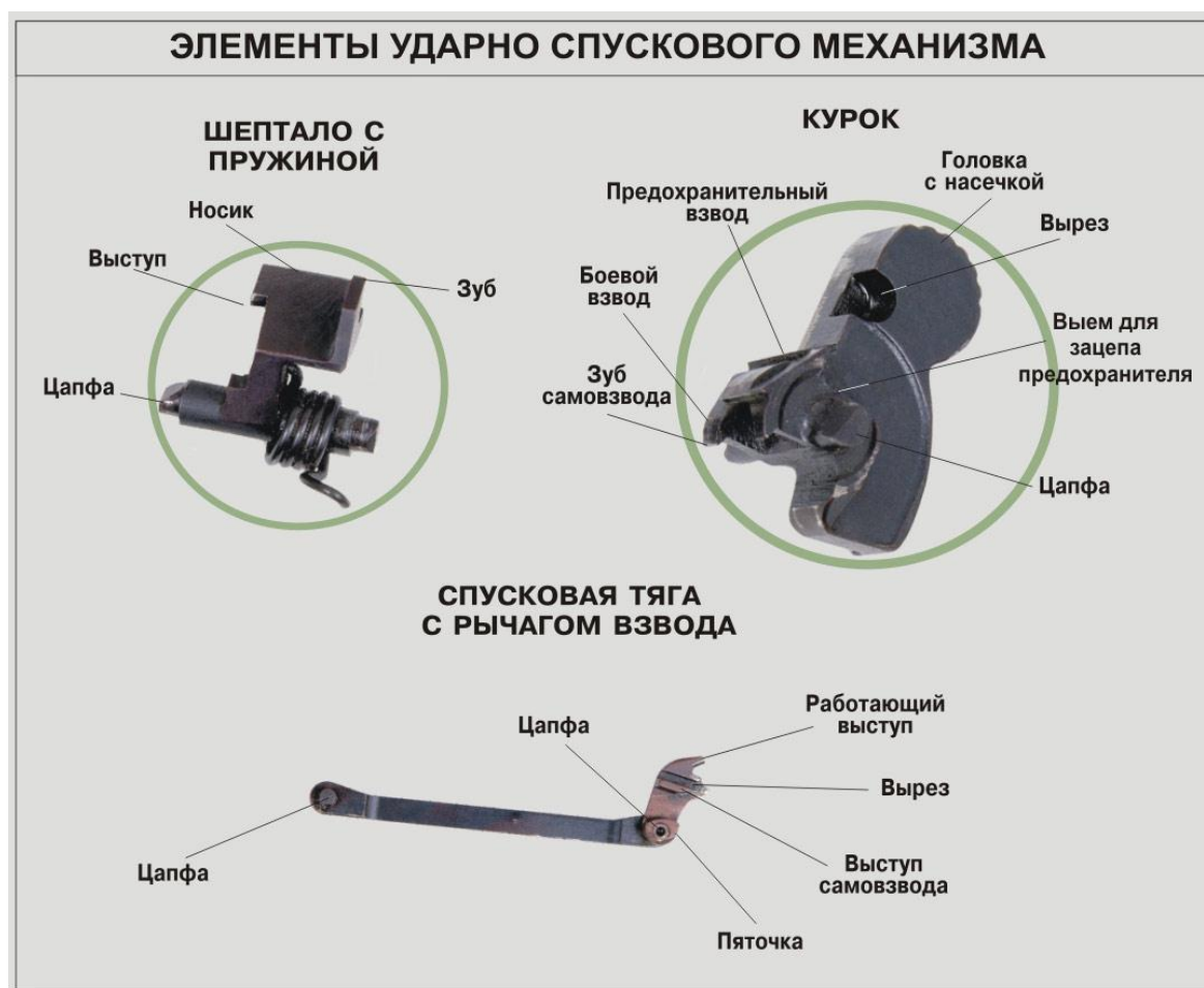
Рисунок 57 – Элементы ударно-спускового механизма пистолета Макарова
