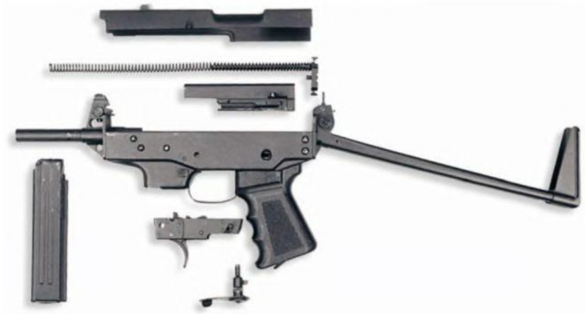
Рисунок 81 – Полная разборка ПП-91 «Кедр»
