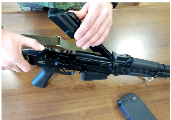
Рисунок 10. Поднять крышку ствольной коробки
