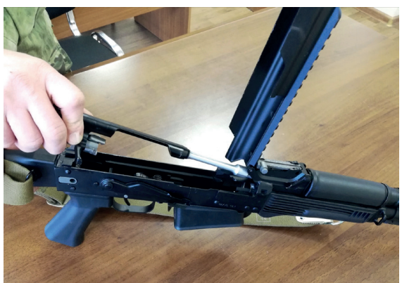
Рисунок 12. Отделить затворную раму с затвором
