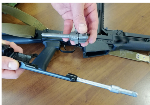
Рисунок 13. Отделить затвор от затворной рамы
