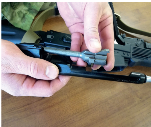
Рисунок 19. Присоединить затворную раму к ствольной коробке
