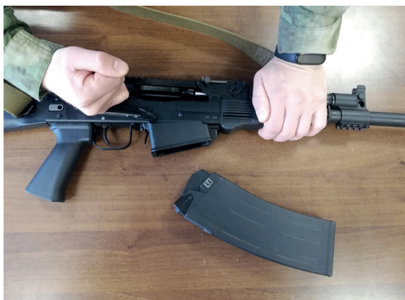
Рисунок 8. Проверить, нет ли патрона в патроннике
