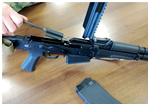
Рисунок 11. Отделить возвратный механизм
