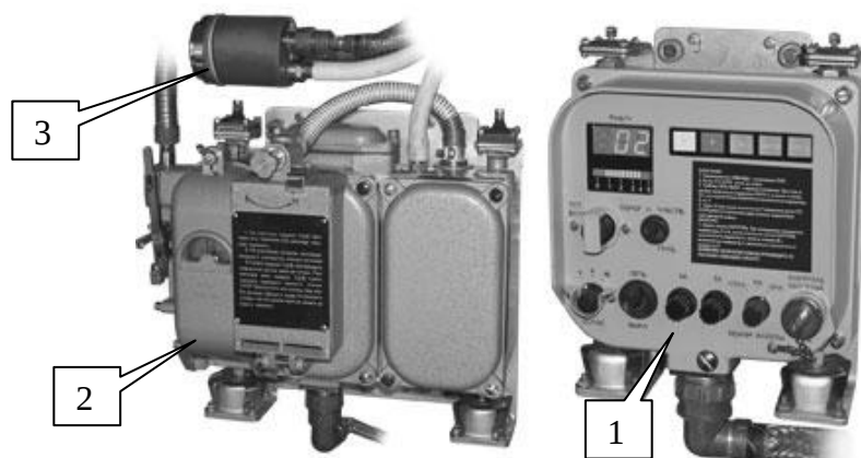
Фото 60. Приборный комплекс ПКУЗ-1А (1 - пульт измерительный, 2 - датчик, 3 - циклон, кабель)
