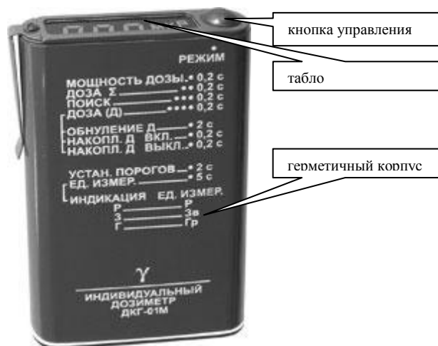
Фото 64. Индивидуальный дозиметр (прямопоказывающий) ДКГ – 01М
