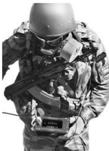
Фото 58. ИМД-2НМ при измерении мощности поглощенной дозы гамма-излучения
