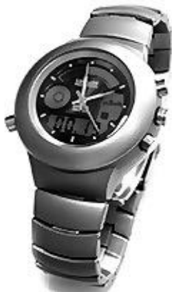
Фото 77. Наручный электронный сигнализатор-индикатор СИГ-РМ1208
