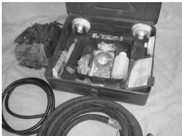
Фото 79. Автомобильный комплект для специальной обработки ДК-4
