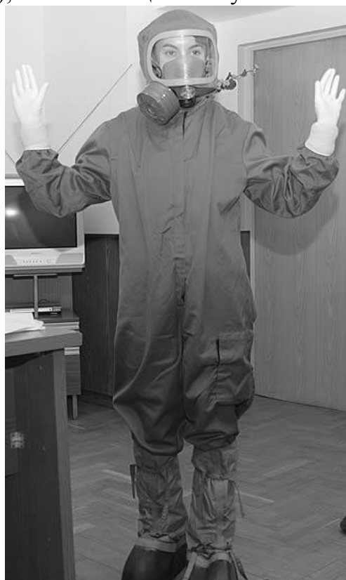
Фото 48. Состав комплекта средств индивидуальной защиты «Кварц» (1 – комбинезон; 2 - шлем (включает защитное стекло и лицевую дыхательную полумаску); 3 – бахилы; 4 – фильтр; 5 - перчатки (2 пары); 6 – полотенце ... и кусочек мыла)
