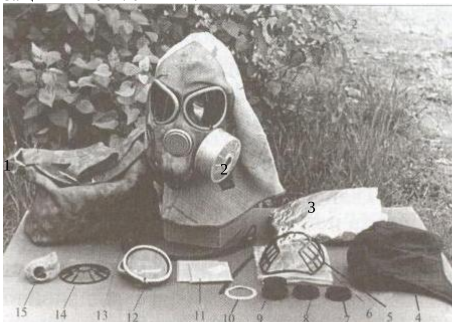
Фото 47. Комплект ПКР (1- сумка; 2 – противогаз ПМК-3 с капюшоном; 3- респиратор РОУ в упаковочном пакете; 4-утеплитель; 5- вкладыш; 6 – мешок водонепроницаемый; 7 – заглушка; 8 – обтекатель; 9 – переходник; 10 – кольцо резиновое; 11 – ПСЗГ; 12 – НМУ; 13 – приспособление для приема воды; 14 – решетка; 15 –чехол)
