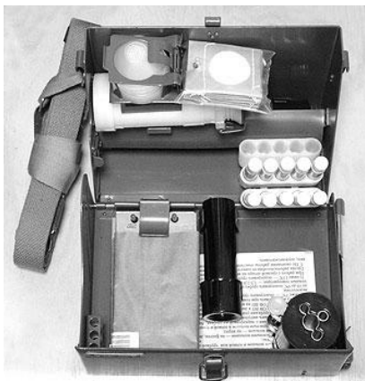
Фото 71, 72 Войсковой прибор химической разведки
