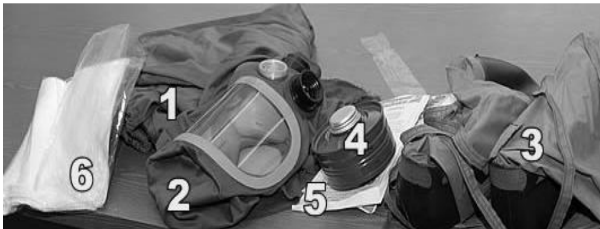
Фото 48. Состав комплекта средств индивидуальной защиты «Кварц» (1 – комбинезон; 2 - шлем (включает защитное стекло и лицевую дыхательную полумаску); 3 – бахилы; 4 – фильтр; 5 - перчатки (2 пары); 6 – полотенце ... и кусочек мыла)
