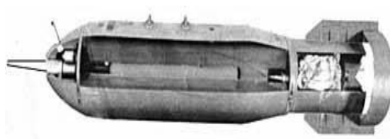
Рис. 19. Объемно-детонирующая авиационная бомба (разрез)
