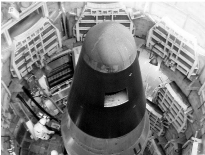
Фото 1. Боеголовка W56 ракеты LGM-30F Minuteman II. Мощность заряда 1,2 мегатонны
