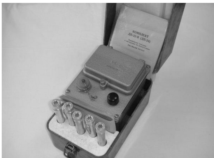
Фото 70. Комплект индивидуальных дозиметров ДП – 24
