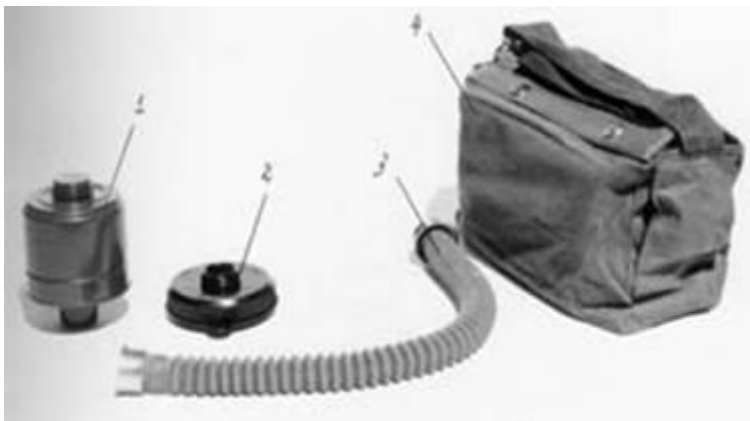
Фото 39. Комплект дополнительного патрона: 1 - дополнительный патрон ДП-2; 2 - противоаэрозольный фильтр; 3 - соединительная трубка; 4 – сумка
