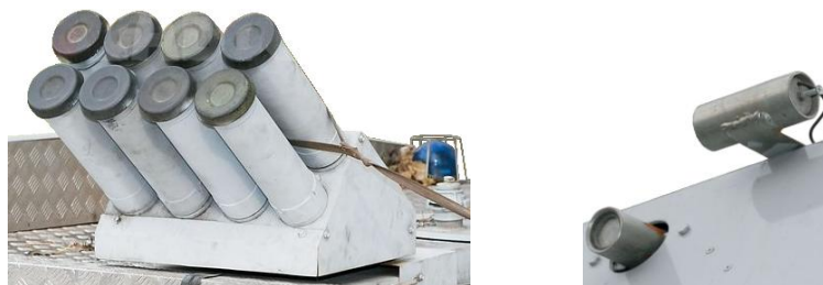
Гранатомет «Туча» и видеокамеры на крыше спецавтомобиля
