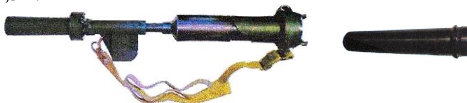
Импульсный распылитель ИР-700 и капсула КР-700
