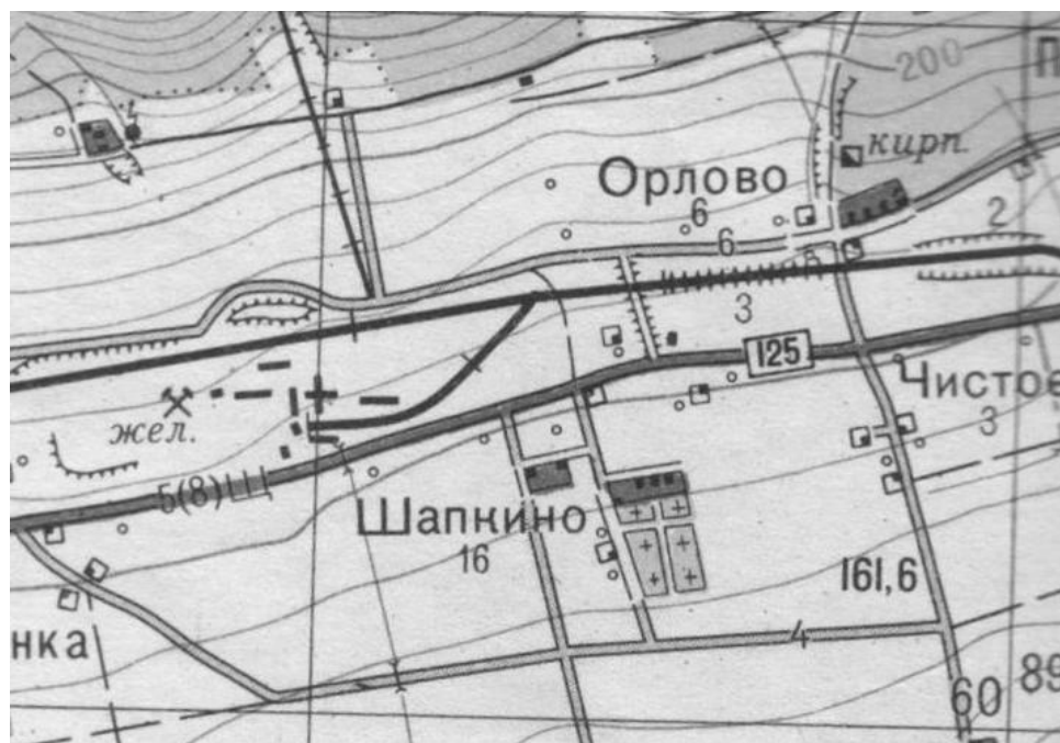
Рис. 26. Определение высот и взаимного превышения точек (высота сечения 5 м)
