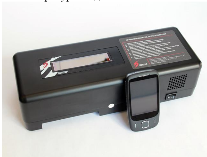
Рисунок 9. Детектор следов взрывчатых и опасных веществ «Сокол».
