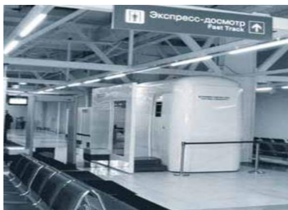
Рисунок 12. Система рентгеновского досмотра пассажиров «СибСкан» в аэропорту Толмачево, г. Новосибирск.
